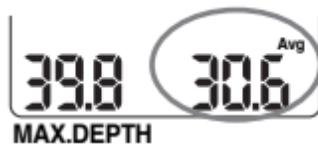
Nell'angolo inferiore destro del display di Digital 330m vengono mostrati, alternativamente, la temperatura dell'acqua e la profondità media: ogni dato viene mostrato per 4 secondi. Durante l'immersione il valore della profondità media viene aggiornato continuamente e rappresenta il valore medio delle profondità registrate dall'inizio dell'immersione.
