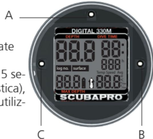
Trascorsi i 5 secondi di auto-test, Digital 330m è pronto all'immersione. Se trascorrono 3 minuti senza che inizi l'immersione o venga effettuata una qualsiasi operazione Digital 330m si spegne per evitare il consumo della batteria.
