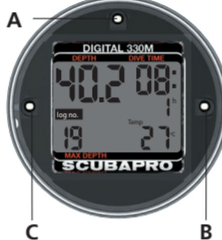
Als u de contacten **B** en **C** met vochtige vingers aanraakt terwijl de Digital 330m in de oppervlaktemodus staat, wordt de logboekmodus geopend. De Digital 330m slaat de relevante gegevens van de laatste 19 duiken op. Een duik wordt alleen in het logboek opgenomen als deze dieper was dan 1,2 meter en langer dan twee minuten.
