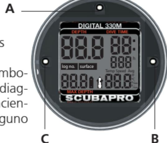
Transcurridos 5 segundos en modo de diagnóstico, el Digital 330m pasa a modo activo. Después de 3 minutos sin funcionar en modo activo, el Digital 330m se apaga automáticamente para ahorrar batería.
