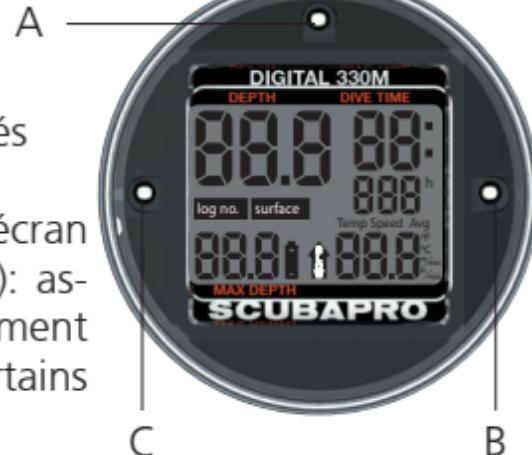
Après les 5 secondes du mode Diagnostic, Digital 330m passe en mode Prêt. Après 3 minutes sans utilisation dans le mode Prêt, Digital 330m s'éteint pour économiser la pile.
