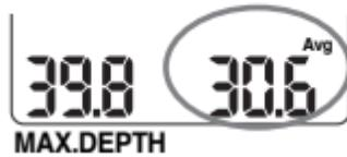
Rechts onder in het scherm wisselen de watertemperatuur en de gemiddelde diepte elkaar af. Iedere waarde wordt gedurende vier seconden weergegeven. De gemiddelde diepte wordt gedurende de gehele duik bijgewerkt en is de gemiddelde waarde van de diepte sinds het begin van de duik.
