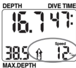
Pendant la remontée, la vitesse de remontée s'affiche dans le coin inférieur droit de l'écran à la place de la température et de la profondeur moyenne. La vitesse de remontée s'affiche en mètres par minute. Dès que Digital 330m ne détecte plus de remontée, la température et la profondeur moyenne réapparaissent. De plus, Digital 330m affiche une flèche lorsqu'il détecte une vitesse de remontée supérieure à la vitesse idéale. La vitesse varie selon la profondeur, comme indiqué dans le tableau.
