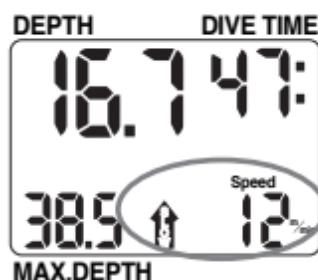
Durante el ascenso, en la esquina inferior derecha se muestra la velocidad de ascenso en lugar de la temperatura y la profundidad media. La velocidad de ascenso se visualiza en metros por minuto. Cuando el Digital 330m detecte que se ha detenido el ascenso, volverá a mostrar la temperatura y la profundidad media. Además, el Digital 330m muestra una flecha cuando detecta una velocidad de ascenso superior a la correcta. Varía según se muestra en la tabla.
