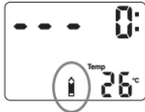
Durante la fase de encendido, el Digital 330m comprueba el estado de la pila. Si queda un 10% de carga o menos de la carga inicial, aparecerá un ícono en forma de pila durante 10 segundos. En este caso, el Digital 330m deberá ser sustituida inmediatamente.
