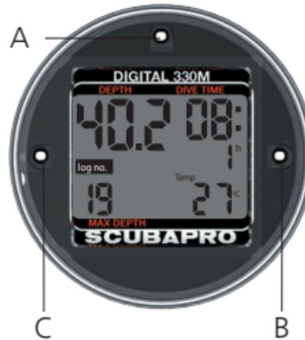
Durch Überbrücken der Kontakte B und C mit angefeuchteten Fingern aktivieren Sie im Oberflächenmodus den Logbuchmodus. Der Digital 330m speichert die wichtigsten Daten der letzten 19 Tauchgänge. Ein Tauchgang wird nur dann ins Logbuch eingetragen, wenn er tiefer als 1,2 Meter war und länger als 2 Minuten dauerte.
