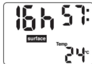
Unterschreitet die Tauchtiefe 1,2 Meter, zeigt das Display während 5 Minuten «--» an. Danach wechselt der Digital 330m in den Oberflächenmodus und zeigt «SURFACE» (Oberfläche) und das Oberflächenintervall an.
