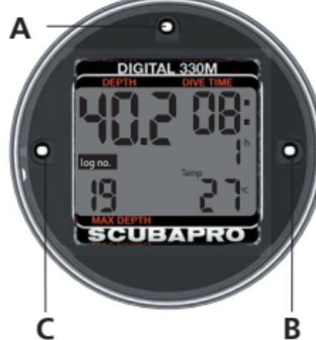
Als u de contacten **B** en **C** met vochtige vingers aanraakt terwijl de Digital 330m in de oppervlaktemodus staat, wordt de logboekmodus geopend. De Digital 330m slaat de relevante gegevens van de laatste 19 duiken op. Een duik wordt alleen in het logboek opgenomen als deze dieper was dan 1,2 meter en langer dan twee minuten.
