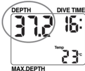
De huidige diepte wordt linksboven in het scherm in meters weergegeven. De dieptemeting is conform internationale normen gekalibreerd voor zoet water. Duikt u in zout water, dan toont de Digital 330m een diepte die iets groter (2-3%) is dan de werkelijke diepte.
