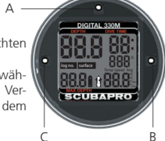
Nach dem Selbsttest wechselt der Digital 330m in den Bereitschaftsmodus. Nach 3 Minuten ohne Bedienung schaltet sich der Digital 330m an der Oberfläche automatisch aus und spart so Energie.
