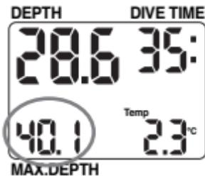
Die maximale Tauchtiefe wird in der linken unteren Ecke angezeigt.
