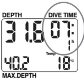
Der Digital 330m zeigt in der oberen rechten Ecke die Zeit, die der Taucher unter 1,2 m verbracht hat. Die Tauchzeit wird in Stunden und Minuten angegeben. Die grösste anzeigbare Tauchzeit beträgt 999 Stunden und 59 Minuten. Danach beginnt die Anzeige wieder bei Null. Wenn die Tauchzeit läuft, blinkt der Doppelpunkt rechts der Minutenanzeige.
