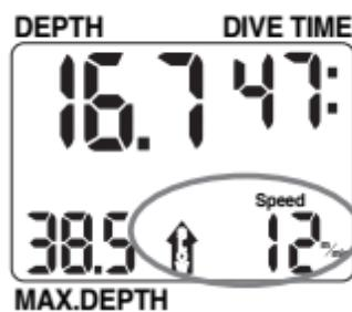
Als u opstijgt, verschijnt rechtsonder in plaats van de temperatuur en de gemiddelde diepte de opstijgsnelheid. Deze wordt weergegeven in meters per minuut. Zodra de Digital 330m registreert dat u niet meer opstijgt, worden de temperatuur en de gemiddelde diepte opnieuw weergegeven.
