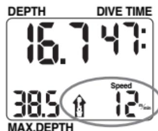
Während eines Aufstiegs zeigt der Digital 330m an Stelle der Temperatur und der durchschnittlichen Tiefe die Aufstiegsgeschwindigkeit. Die Aufstiegsgeschwindigkeit wird in Meter pro Minute angezeigt.
