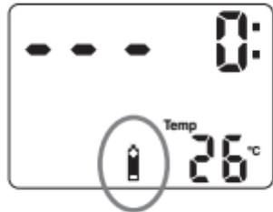
Pendant la phase de mise en route, Digital 330m vérifie l'état de sa pile. S'il reste 10% d'énergie ou moins par rapport à la charge initiale, le symbole "pile" s'affichera pendant 10 secondes. Il faut alors remplacer immédiatement le Digital 330m.
