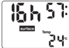
A profondità inferiori a 1,2 m l'indicazione della profondità sul display viene sostituita da [--]. Al termine dell'immersione queste lineette vengono mostrate per 5 minuti, poi Digital 330m entra in modalità superficie, sul display compaiono l'icona "SURFACE" sul display e la durata dell'intervallo di superficie. L'intervallo verrà mostrato per 24 ore o fino a quando non viene effettuata un'altra immersione. In modalità superficie Digital 330m indica la temperatura dell'aria.
