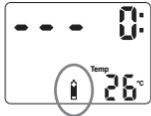
Durante la fase di accensione, Digital 330m controlla lo stato della batteria. Se la carica rimanente è pari o inferiore a 10% verrà mostrata sul display, per 10 secondi, l'icona batteria. In questo caso l'unità deve essere immediatamente sostituita.
