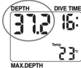
Die aktuelle Tauchtiefe wird in der oberen linken Ecke des Displays in Metern angezeigt. Die Tiefenmessung ist, wie international üblich, auf Süßwasser geeicht. Deshalb zeigt das Gerät beim Tauchen in Salzwasser einen Tiefenwert an, der die tatsächliche Tiefe um 2 – 3 % übersteigt.
