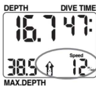
Durante la risalita la velocità viene indicata nell'angolo inferiore destro, al posto della temperatura e della profondità media. La velocità di risalita viene indicata in metri al minuto. Quando Digital 330m rileva l'interruzione della risalita torna a mostrare la temperatura e la profondità media.
