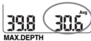
En la esquina inferior derecha de la pantalla, el Digital 330m alterna la información de la temperatura del agua y la profundidad media. Cada valor se muestra durante 4 segundos cada vez. La profundidad media se actualiza constantemente durante toda la inmersión y representa el valor medio de la profundidad desde el comienzo de la inmersión.
