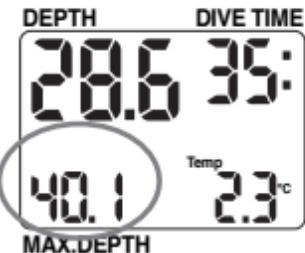
La profondità massima dell'immersione viene indicata nell'angolo inferiore sinistro del display.
