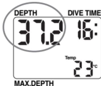
La profondeur actuelle s'affiche dans le coin supérieur gauche de l'écran, en mètres. Selon les standards internationaux, la mesure de la profondeur est calibrée en eau douce. Par conséquent, lors des plongées en eau salée, Digital 330m affichera une profondeur légèrement supérieure à la profondeur réelle (2 à 3% supérieure).
