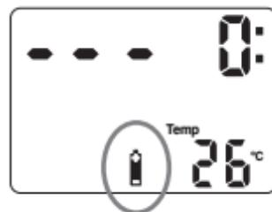
Der Digital 330m prüft nach dem Einschalten den Batteriezustand. Erreicht die Batteriekapazität 10% der anfänglichen Kapazität oder weniger, wird 10 Sekunden lang das Batteriesymbol angezeigt. In diesem Fall muss das Gerät umgehend ausgetauscht werden.
