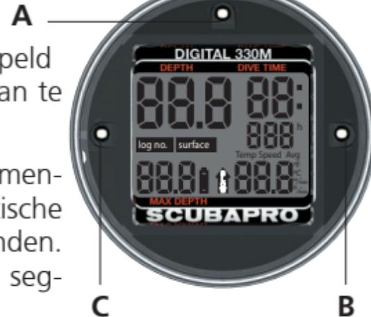
Na vijf seconden in de diagnostische modus schakelt de Digital 330m naar de modus 'gereed'. Als de Digital 330m niet binnen drie minuten nadat deze is overgeschakeld naar de modus 'gereed', wordt bediend, schakelt het instrument zichzelf uit om de batterij te sparen.
