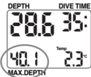
De maximale diepte wordt linksonder in het scherm getoond.
