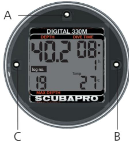
En mode Surface, si les contacts B et C sont reliés avec les doigts mouillés, Digital 330m passe en mode Carnet de Plongée. Digital 330m stocke les données des 19 plongées les plus récentes. Une plongée ne sera mémorisée dans le carnet de plongée que si sa profondeur était supérieure à 1.2 m et sa durée supérieure à 2 minutes.
