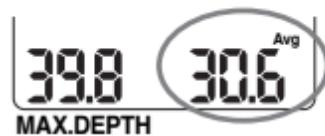
Der Digital 330m zeigt in der rechten unteren Ecke abwechselnd die Wassertemperatur und die durchschnittliche Tiefe (Avg, average depth). Jeder Wert wird jeweils für 4 Sekunden angezeigt.
