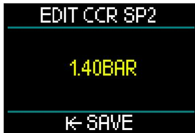
Diese Anzeige zeigt ein Beispiel der Einstellung von Setpoint 2. Der Setpoint 2 kann zwischen 1,0 bis 1,6 bar eingestellt werden.
