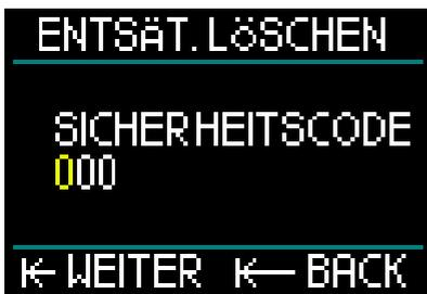
Gib die erste Zahl des Sicherheitscodes ein, gefolgt von einem Drücken-und-Loslassen, wiederhole dasselbe Verfahren für die zweite und die dritte Zahl.
