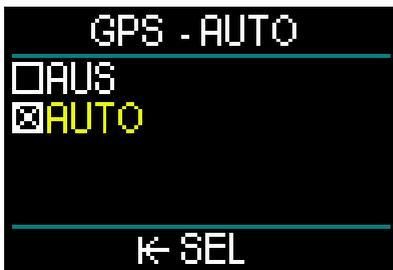
Im Modus GPS AUTO kannst du durch Drehen der Radtaste auf der Oberflächenanzeige die aktuelle Zeit, das Datum sowie deine GPS-Koordinaten sehen. Zudem wird die Richtung (TH) zum derzeit eingestellten Wegpunkt und die Gesamtdistanz (TD) zu diesem Wegpunkt angezeigt.
