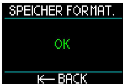
**HINWEIS:** Wenn die Kommunikation des HUD beim Schreiben auf den Flash-Speicher unterbrochen wird oder die Batterie des HUD zur Neige geht, während der Flash-Speicher verwendet wird, kann der Speicherinhalt beschädigt werden. In diesem Fall kannst du auch diese Funktion zum Formatieren des Speichers verwenden.
