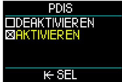
Die Funktion PDIS (profilabhängiger Zwischenstopp) des HUD berechnet basierend auf der Stickstoffsättigung deines Körpers aus dem aktuellen und aus vorherigen Tauchgängen sowie entsprechend des Atemgasgemisches einen Zwischenstopp. Das Aktivieren der Funktion PDIS ist nur möglich, wenn du mit dem Algorithmus ZHL-ADT tauchst. Nach dem Speichern der Auswahl durch Drücken der Radtaste kehrst du zum Menü Taucheinstellungen zurück.
