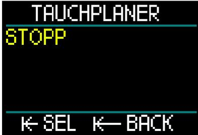
Nachdem die Simulation beendet ist und während 1 Minute keine Eingabe gemacht wird, wird automatisch wieder die Oberflächenanzeige erscheinen.
