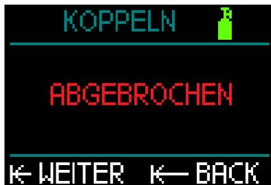
**HINWEIS:** Der Sender darf vor der Kopplung mindestens während 40 Sekunden nicht unter Druck stehen, da er sonst keine Kopplungssequenz sendet.
