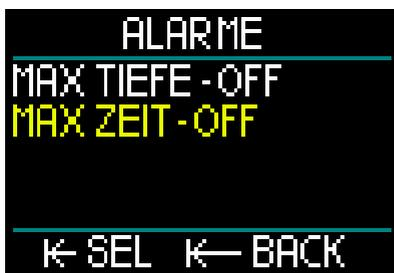
Durch Drehen der Radtaste kann der Wert der maximalen Zeitwarnung in Schritten von 1 Minuten. zwischen 1 und 995 Minuten eingestellt werden. Drücken-und-loslassen der Radtaste, um den eingestellten Wert zu speichern und den Alarm zu aktivieren. Um den Alarm für die maximale Tauchzeit zu deaktivieren, drücke und halte die Radtaste.
