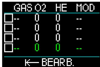
Nachdem dieses Gas hinzugefügt wurde, wird der Dekompressionsplan sofort neu berechnet.
