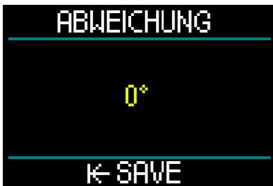
Die Einstellungen deiner magnetischen Deklination hängt von deinem Standort auf der Erde ab. Die Deklination deines Standorts findest du mit einer einfachen Google-Suche. Die möglichen Korrekturwerte des HUD liegen zwischen -90 Grad (Westen) und +90 Grad (Osten) in Schritten von 1 Grad. Ist die Deklination einmal eingestellt, muss sie erst verändert werden, wenn du woanders hin reist.
