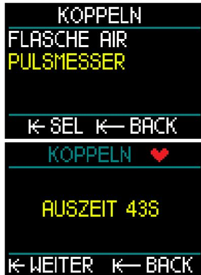
2. Nimm das Sendemodul des Pulsmessers, lege es in die Nähe des HUDs, berühre die beiden Metalldruckknöpfe auf der Rückseite des Pulsmessers und überprüfe die Anzeige auf dem Display des HUDs.
