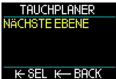
Der Tauchplaner wird in der ersten Ebene geöffnet. Wähle Nächste Ebene, Drücken-und-loslassen der Radtaste.
