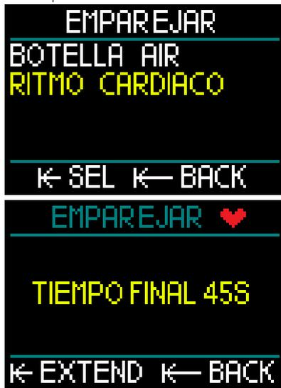
2. Coja el módulo transmisor del cardiofrecuencímetro, colóquelo cerca de HUD, toque los dos botones de sujeción metálicos de la parte posterior del módulo de frecuencia cardíaca y compruebe la indicación mostrada en la pantalla de HUD.
