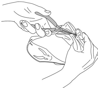
10. Corte las bridas utilizando el cortador lateral. Corte todo el material sobrante, con precaución para que los extremos queden lisos y no perforen la silicona.
