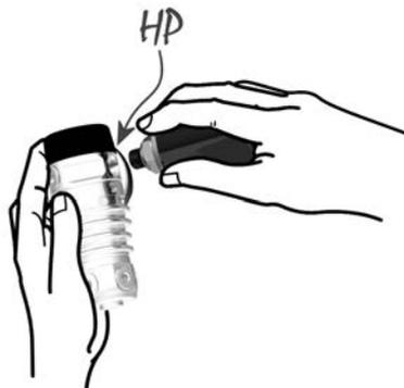
☞ *NOTA: Enrosque el transmisor en el puerto de alta presión de la primera etapa con las manos y utilice una llave adecuada para apretar. Tenga precaución para no apretarlo en exceso.*
