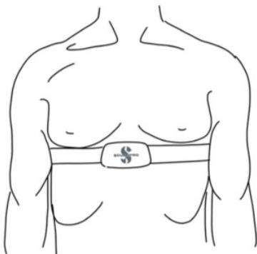
Ajuste la correa para que le resulte cómoda, pero quedando lo suficientemente ceñida para permanecer en su sitio. Si utiliza un traje de buceo, el monitor de la frecuencia cardíaca debe estar en contacto directo
