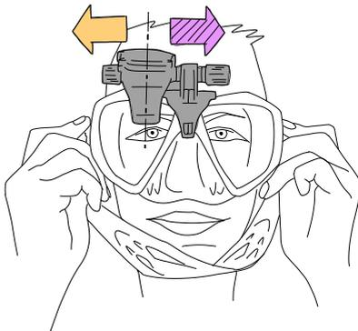
En la imagen de ejemplo, es necesario desplazar HUD hacia la derecha (flecha morada) para alinearlo con la línea de visión del buceador. Esto significa que es necesario reducir la distancia entre HUD y el soporte. Puede conseguir este resultado cambiando la posición de los separadores.
