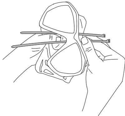
Deslice una brida hacia abajo por el lado izquierdo del alojamiento para la nariz y la otra por el lado derecho. Una vez que haya finalizado, compruebe que las bridas estén correctamente colocadas.
