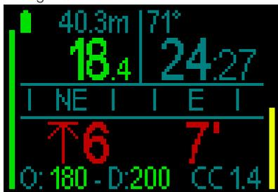
Esempio di una schermata che indica sulla riga inferiore a destra l'SP2 e a sinistra l'ossigeno/diluente.
