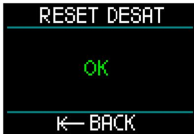
☞ **NOTA:** dopo un azzeramento della desaturazione il cambio tra i Modi Scuba, Profondimetro, Apnea e CCR è immediatamente possibile. Tuttavia, poiché i Modi Profondimetro e Apnea non monitorano la saturazione di azoto nei tessuti, si raccomanda di mantenere gli intervalli iniziali previsti per i cambi di modo.
