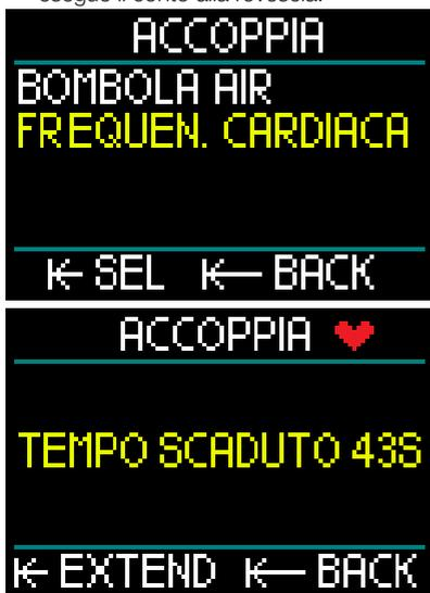
2. Prendere il modulo sonda del cardiofrequenzimetro, collocarlo vicino a HUD, toccare i due fermi metallici a scatto sul retro del modulo del cardiofrequenzimetro e controllare l'indicazione visualizzata sul display di HUD.
