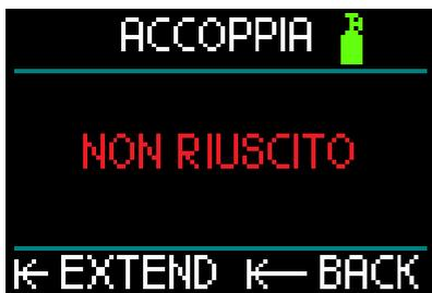
**NOTA:** è necessario che la sonda non sia stata pressurizzata per minimo 40 secondi prima di tentare un'operazione di accoppiamento, altrimenti non è in grado di trasmettere l'apposita sequenza.
