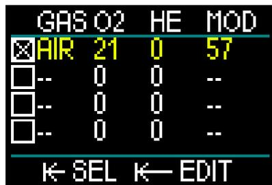
HUD consente la programmazione o modifica di massimo 8 gas. Quando si impostano i livelli di ossigeno ed elio, viene automaticamente visualizzata la massima profondità operativa (MOD)
