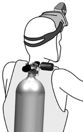
Affinché HUD visualizzi il livello di pressione della bombola con una sonda Smart, occorre prima eseguire l'accoppiamento. Questo passaggio va eseguito solo una volta per ciascuna sonda.
