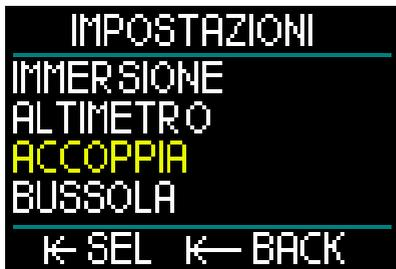
La voce successiva del menu Impostazioni è Accoppia. In questo menu è possibile stabilire la connessione wireless tra HUD e la sonda di pressione Smart o il cardiofrequenzimetro digitale.
