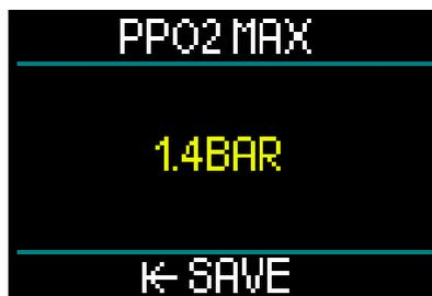
L'impostazione della ppO<sub>2</sub>max determina il limite per la pressione parziale di ossigeno. È la stessa per tutti i gas. HUD consente di impostare la ppO<sub>2</sub> max da 1,3 bar a 1,6 bar (1,4 bar è l'impostazione di fabbrica).
