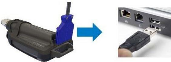
3. Una volta visualizzata la modalità di ricarica, premere il pulsante sinistro sul dispositivo G2C per selezionare "DISK". **NOTA BENE:** È possibile che appaia una finestra di piccole dimensioni sul PC che consiglia di eseguire la scansione e correggere eventuali errori sul proprio dispositivo G2C. Può trattarsi di un problema di riconoscimento e non c'è nulla di cui preoccuparsi. Basta seguire i passaggi consigliati mostrati sul proprio PC
