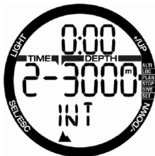
中央の行の左側には現在の高度クラスが、右側には禁止高度が表示されます。上の例では、現在ダイバーは高度クラス2にいて、3000m以上の高度(クラス3)に移動してはいけません。
