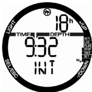
ダイバーが移動してもよい高度がプランナーメニューの最初のページに表示されます。禁止高度とは、現在の体内残留窒素レベルでダイビングを行ってはならないと Chromis が算出した高度であり、画面の2番目の高度より上のレベルです。詳しくは、「高度と減圧アルゴリズム」の章を参照してください。
