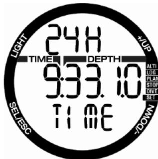
上の画面では、メニューに現在時刻が表示されています。SELボタンを押すと、上の行で24hまたは12h設定が点滅を始めます。+ボタンまたは-ボタンを押して設定を変更できます。SELボタンを押すと、時間設定が有効になります。時間が点滅を始め、秒が00にリセットされます。+ボタンと-ボタンで時間を変更できます。SELボタンを押すと、選択対象が分になり、変更可能になります。SELを押して、新しい設定を確定します。
