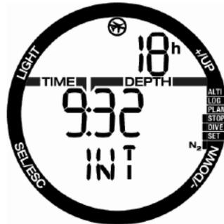
ダイビング後、Chromisには最後のダイビング終了後の水面休息時間が表示されます。水面休息時間カウンターは、体内残留窒素の排出が完了するまでカウントを続けます。排出完了後、このメニューは消えます。
