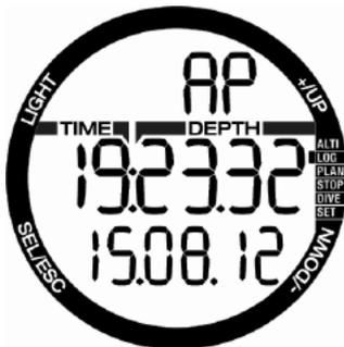
SELボタンを押すとアブネアダイブセッションが開き、ダイブが順番に、最長時間と深度とともに表示されます。上の行には、セッションでのアブネアダイブ数が表示されます。中央の行には、潜水時間が秒で表示されます。最大深度は中央の行の右側に表示されます。
