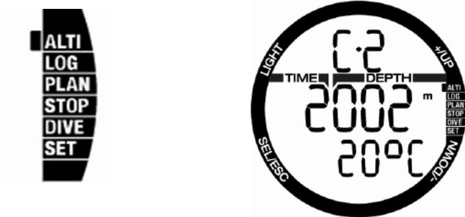
高度メニューでは、現在の高度を気圧から計算します。現在の高度クラスが上の行に表示されます。下の行には現在の温度が表示されます。
