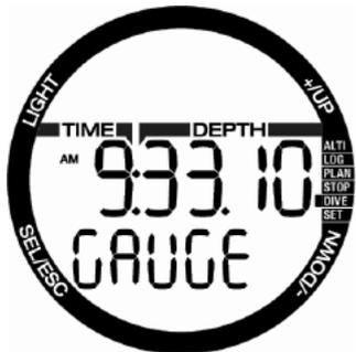
Chromisをゲージモードに設定すると、深度、時間、温度のモニターのみが行われ、減圧計算は一切行われません。体内残留窒素が完全に排出されている場合のみ、ゲージモードに切り替えることができます。バッテリー残量低下アラームを除き、すべての警告およびアラーム（音声と画面表示）が無効化されます。
