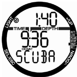
「no dive」シンボルとカウントダウンタイマーが上の行に表示され、体内のマイクロバブル、CNS、または残留窒素が高いため次のダイビングを行ってはいけない期間を示します。
