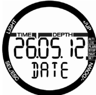
日付設定でSELボタンを押すと、最初に表示されるブロック(24hモードでは日、12hモードでは月)が点滅し、+ボタンまたは-/DOWNボタンを押して変更できるようになります。SELボタンを押すと、次のブロックが点滅を開始し、+ボタンまたは-/DOWNボタンを押して変更できます。またSELボタンを押すと、ドットの後の年ブロックが点滅を開始します。SELボタンを押して、日付設定を確定します。
