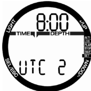
デュアルタイムはメインクロックと同じ「基準時間」を使用します。そのため、「**時間と24hまたはAM/PMモードを設定する**」の章に従って時間を変更すると、デュアルタイムも影響を受けます。デュアルタイムゾーン選択では、メインクロックの時間との差を定義します。タイムゾーン選択を「OFF」にすると、デュアルタイムは無効になります。SELボタンを押すと、UTC2時間が点滅を始めます。+ボタンまたは-ボタンを押して設定を+14h~-13hの範囲内で(または「off」)に変更できます。SELボタンを押すと分が点滅を始め、+ボタンまたは-ボタンで15分刻みで分を変更できます。SELボタンを押して、UTC2設定を確定します。
