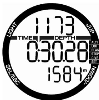
スイムモードでは、上の行にキック数が表示されます。中央では、開始後の経過時間がカウントされます。変換された距離が、下の行に表示されます。
