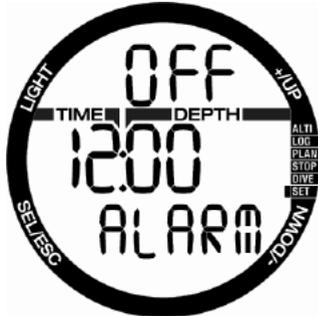
SELボタンを押すと、アラームの状態が点滅を始め、+/UPボタンまたは-/DOWNボタンを押すと「on」か「off」を選択できます。SELボタンを押すと、アラーム時間が点滅を始めます。時間設定は、+ボタンまたは-ボタンを押してスクロールします。SELボタンを押すと分が点滅を始め、+ボタンまたは-ボタンを押すとスクロールできます。SELボタンを押すと、設定が確定します。
