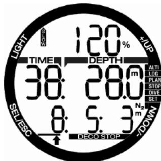
また、最適浮上速度の110%を超えると、アラーム音が鳴ります。アラーム音は、最適浮上速度からの超過率に比例して強くなります。
