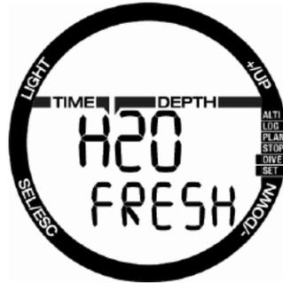
このメニューでSELボタンを押すと、淡水または海水の設定が下の行で点滅を始めます。+ボタンまたは-ボタンを押して2つの設定を切り替えて、SELボタンで選択を確定します。
