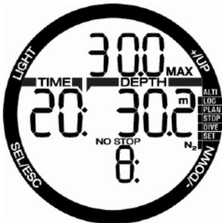
MODを超えると、上の行でMODが「MAX」シンボル付きで点滅し、MODをどれくらい超過したのかを確認できます。さらに、ビープ音も起動します。深度の点滅とビープ音は、MODより浅い場所に浮上するまで鳴り続けます。
