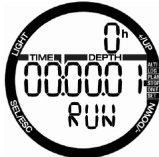
+ボタンを押すと、ストップウォッチのカウントが始まり、実際の状態「run」が表示されます。+ボタンをもう一度押すと、ストップウォッチのカウントが終わり、実際の状態「stop」が表示されます。カウント時間は画面に表示されたままになります。
