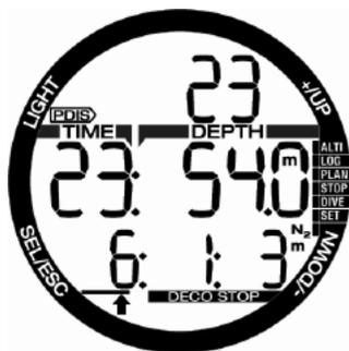
減圧停止せずにPDI停止の深度まで浮上すると、PDISシンボルと深度が上の行で点滅を始め、下の行には2分間のカウントダウン時間が表示されます。
