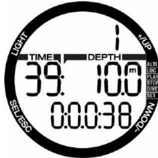
ダイビング中のアプネアモード画面では、上の行にダイビングの連番が表示されません。中央の行には潜水時間(秒)と最大深度が表示されます。下の行には、浮上速度が表示されます。
