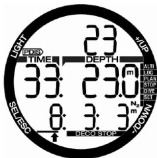
減圧停止が必要になっている場合、減圧停止の情報が下の行に残されます。この場合、PDISカウンターは表示されませんが、PDISシンボルと深度のみが上の行で2分間点滅し、この間はPDISゾーンに留まることが推奨されます。
