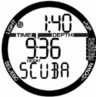
ダイビング禁止警告がコンピューター画面に表示されている場合は、ダイビングを行わないでください。(CNS O<sub>2</sub>が40%を超えたことではなく)マイクロバブルの蓄積によりこの警告が発生し、この警告を無視してダイビングを行うと、無減圧限界時間が短くなるか、減圧停止時間が長くなります。さらに、ダイビング終了時のマイクロバブル警告の発生時間が大幅に長くなります。
