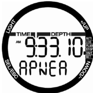
Chromisには、最先端のアプネアダイビングモードが搭載されています。主な特長としては、通常のスキューバモードよりサンプリング速度が高速で、アラーム機能がアプネアダイビングに最適化されています。
