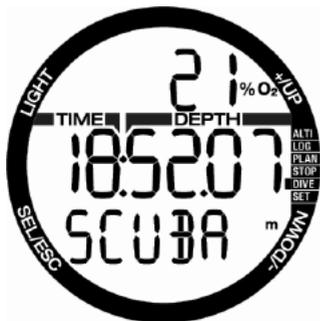
ただし、ダイビング後のスキューバモードでは、次のような画面が表示され、上の行には反復潜水禁止時間が、中央の行には体内残留窒素排出時間が表示されます。
