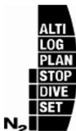
この画面には、体内残留窒素量が右側のインジケータ付きで表示され、最初のバーにはN<sub>2</sub>と表示されています。
