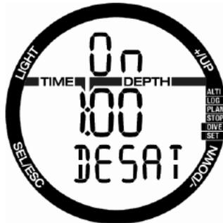
SELボタンを押すと、「on」選択が点滅を始めます。+ボタンまたは-ボタンを押して体内残留窒素排出時間を無効にでき、このことは選択が「off」になったことからわかります。SELボタンを押して「off」状態を確定すると、コードページが表示されます。最初のブロックが点滅を開始し、+/-を押すと編集できます。SELボタンを押すと数字が確定され、次のブロックが点滅を開始します。コードを正しく入力してSELボタンで確定し、体内残留窒素排出時間のリセットを完了します。
