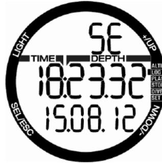
ログブックのメインページには開始日時が表示されます。SELボタンを押すとキック数が表示され、時間と距離がログに表示されます。
