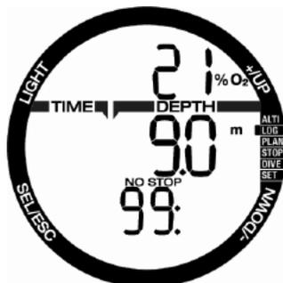
水面休憩時間が提示されているか、体内残留窒素排出時間が終了すると、プランナーで深度が点滅を始めます。+または-を押し、深度を3m/10フィート刻みで深度を設定できます。
