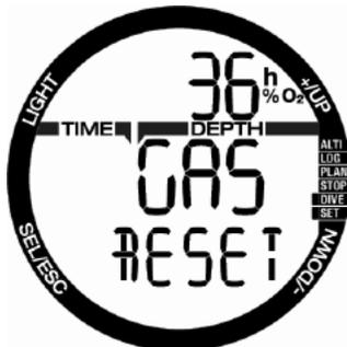
SELボタンを押すと、上の行の時間が点滅を始めます。時間は1～48時間の間で選択できます。あるいは、+ボタンまたは-ボタンを押してナイトロックスリセット時間を表示することができます。「--h」と表示されている場合、ガスのリセット時間は無効です。
