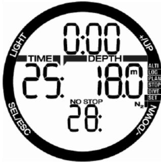
停止して画面に表示した状態で-ボタンを長押しすると、タイマーはゼロにリセットされます。
