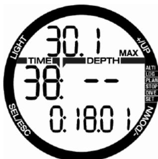
ゲージモードでのダイビング中は、下の行にストップウォッチが表示されます。-ボタンを押すとストップウォッチが停止します。ストップウォッチが停止した状態で**ボタンを押し続けると**、ストップウォッチがリセットされ、再開します。
