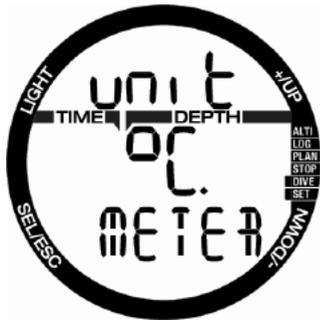
このメニューでSELボタンを押すと、温度単位のフィールド値が点滅を始めます。+ボタンまたは-ボタンを押して、値を°C/°Fで変更できます。SELボタンを押すと、距離フィールドが点滅を始めます。もう一度+/-を押して、値をメートルとフィートで変更できます。ESCボタンを押すと、温度と距離の単位設定が確定します。
