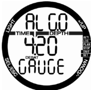
スキューバモードでダイビングを行った後は、体内残留窒素排出時間が経過した後で、ゲージモードまたはアブネアモードに切り替え可能になります。
