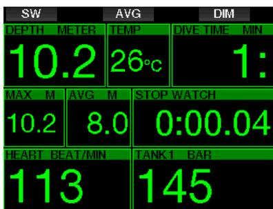
Cuando G2TEK está configurado en modo Consola, solo monitoriza la profundidad, el tiempo y la temperatura, y no realiza ningún cálculo de descompresión. Solo podrá cambiar al modo Consola si el ordenador está completamente desaturado. Todas las advertencias y alarmas sonoras y visuales quedarán desactivadas, a excepción de las de pila baja, reserva de la botella, media botella, profundidad máxima, tiempo máximo de inmersión y la alarma de la señal de la presión.
