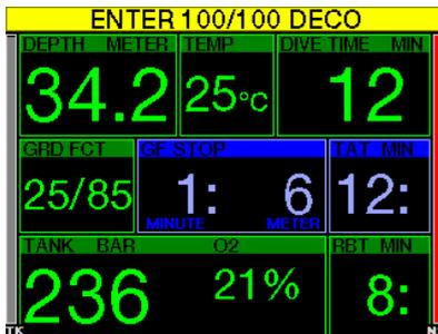
En inmersiones con un ajuste de GF distinto a 100/100, la información de 100/100 subyacente no se puede visualizar directamente en la pantalla (pero se puede visualizar como información alternativa). Puede configurar G2TEK para que le avise cuando esté a punto de entrar en una obligación de descompresión en inmersiones con un ajuste de GF distinto a 100/100.
