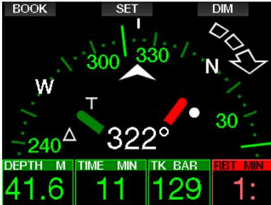
En caso de paradas de GF o descompresión, el ángulo inferior derecho cambiará cada 4 segundos entre la información de descompresión y la presión de la botella junto con el RBT.
