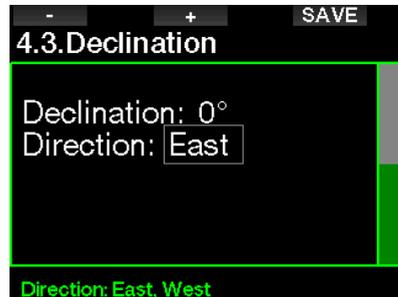
☞ **NOTA:** La brújula de G2TEK no suele requerir ninguna calibración. Si detecta alguna desviación permanente significativa en la dirección de la brújula, póngase en contacto con un distribuidor autorizado de SCUBAPRO.
