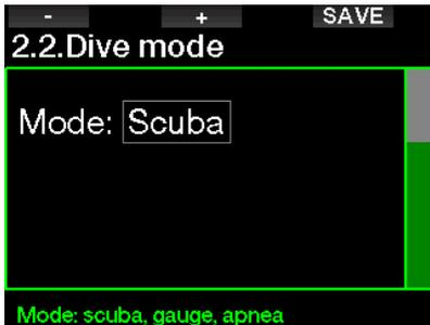
**유의사항:** 게이지 모드와 프리다이빙 모드는 조직 포화를 추적하지 않기 때문에, 게이지 모드와 프리다이빙 모드에서 이전 다이빙을 수행한 시간과 스쿠버 다이빙 모드로 변화가 가능한 시간 사이에는 48시간 간격 동안에 잠금이 발생하게 됩니다. 반대로, 아래에서 표시된 G2TEK는 스쿠버 모드로 다이빙을 했기 때문에 불포화 시간이 경과하기 전까지는 게이지 모드나 프리다이빙 모드로 변경될 수 없습니다.
