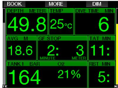
[MORE] 버튼을 길게 누르면 가스 요약표가 나타납니다. [MORE] 버튼을 길게 누르면 예측된 감압 정지가 활성화된 모든 사용 가스(PMG)와 더불어 표시되고, 현재 가스(1G)만 사용되는 것으로 가정합니다. 또한 현재 선택된 GF 정지 및 GF 100/100 스케줄도 표시됩니다.
