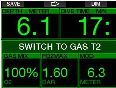
상승 단계 동안에, 현재 사용하고 있는 가스가 아닌 다른 한 가스의 MOD에 상응하는 수심에 도달하면, G2TEK는 가스 믹스의 스위치를 수행하라고 제시하게 됩니다. 일련의 청취 사운드가 생성되고 디스플레이에 **SWITCH TO GAS T2** 메시지가 나타납니다. 다이버는 30초 내에 이 메시지에 반응해야 합니다. 다이버가 반응하지 않는 경우, G2TEK는 가스 2가 사용되지 않는 것으로 결정(T2 가스 배제 메시지가 표시됨)하고 이에 따라 감압 스케줄을 조정합니다.
