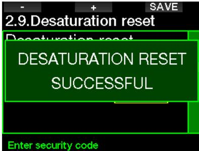
☞ **유의사항:** 불포화 재설정 후에는 즉시 스쿠버, 게이지, 프리다이빙 모드로의 변경이 가능하게 됩니다. 하지만 게이지 모드와 프리다이빙 모드에서는 조직의 질소 축적을 추적하지 않기 때문에 모드 변경 사이의 기본적 인터벌을 유지하는 것이 권장됩니다.
