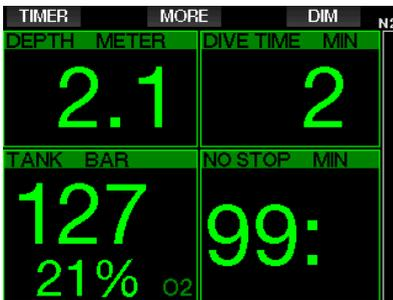
☞ **유의사항:** 무정지 시간과 RBT 사이가 단축될 경우에만 **라이트** 스크린 형태가 나타납니다. RBT=0분에 도달하기 직전에 GF 단계나 감압 단계에 진입할 잔여 가스 공급인 경우에, 'NO STOP'이라는 라벨이 강조되면서 무정지 시간이 스크린에 표시됩니다. 반면에, 잔여 가스 공급이 RBT=0분에 도달할 예정이고 여전히 무정지 단계에 있는 경우에는, 'RBT' 라벨이 강조되면서 RBT가 스크린에 표시됩니다.
