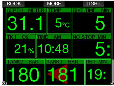
**지원된 가스 스위치:** 탱크를 수동으로 선택하여 언제든지 끈고된 탱크 스위치를 뒤늦게라도 수행할 수 있습니다. [BOOK] 버튼을 길게 누르면 탱크 스위치 절차가 시작됩니다. G2TEK는 디스플레이에 SWITCH TO GAS T2 메시지를 표시합니다. 이를 통해 권장되는 탱크로 탱크 스위치를 수행하고 있음을 검증할 수 있게 됩니다. 이 때에, [SAVE] 버튼을 누르면 스위치가 확인됩니다. G2TEK는 SWITCH TO GAS T2 SUCCESSFUL 메시지를 표시합니다.
