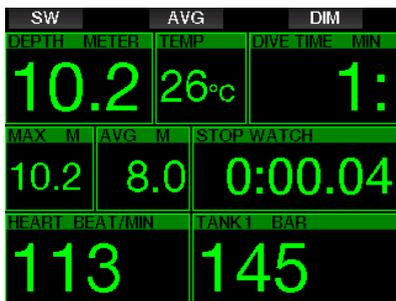
Quando o G2TEK estiver definido para o modo Profundímetro, ele apenas irá monitorar a profundidade, hora e a temperatura, não realizando nenhum cálculo da descompressão. Somente poderá passar para o modo Profundímetro se o computador estiver totalmente dessaturado. Os demais avisos e alarmes visuais e sonoros, além dos de bateria fraca, reserva do cilindro, meio cilindro, profundidade máxima, tempo máximo de mergulho e o alarme do sinal de pressão, estarão desligados.
