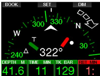
No caso de paradas com GF ou descompressão, o canto inferior direito alterna a cada 4 segundos entre as informações de descompressão e a pressão do cilindro juntamente com o RBT.
