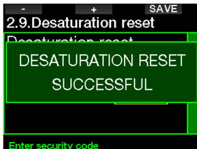
👉 *NOTA:* Após o reset (redefinição) da dessaturação, é possível efetuar-se imediatamente a mudança entre os modos SCUBA, Profundímetro e Apneia. No entanto, como os modos Profundímetro e Apneia não estão rastreando a sua carga de nitrogênio nos tecidos, recomendamos que mantenha os intervalos iniciais entre as alterações nos modos.
