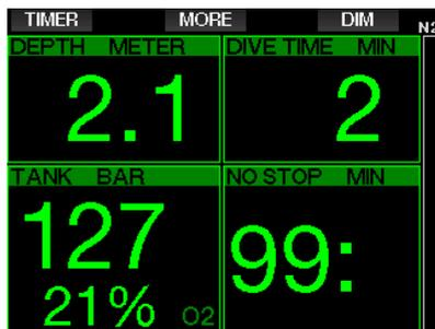
☞ **NOTA:** apenas o menor tempo entre o tempo sem paradas e o RBT é mostrado na configuração **LIGHT**. Se o suprimento de ar restante indicar paradas com **GF** ou de descompressão antes de atingir um **RBT** de 0 minutos, o tempo sem paradas será exibido na tela, destacado pelo marcador **NO STOP**. Se, por outro lado, seu suprimento de ar restante indicar que você atingirá o **RBT** de 0 minutos ainda na fase sem paradas, o **RBT** será exibido na tela, destacado pelo marcador **RBT**.
