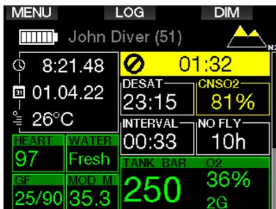
A CNS O<sub>2</sub> aumenta quando a pressão parcial de oxigênio for superior a 0,5 bar e diminui quando essa pressão for inferior a 0,5 bar. Desta forma e enquanto estiver à superfície respirando o ar, o seu marcador de CNS O<sub>2</sub> estará sempre diminuindo. Durante o mergulho, a profundidade na qual o valor de 0,5 bar é alcançado para diferentes misturas é a seguinte:
