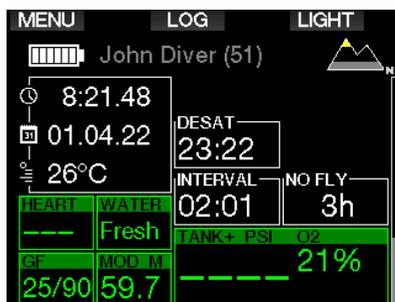
As classes proibidas de altitude são mostradas em segmentos amarelos (cor dos ajustes iniciais de fábrica) dentro do ícone estilizado de montanha. Estes segmentos podem ser combinados com segmentos cinza (cor com a configuração inicial de fábrica) que indicam a altitude atual. No exemplo acima, o mergulhador encontra-se presentemente em uma classe de altitude 1 e não deve atingir altitudes da classe 4 ou superior.
