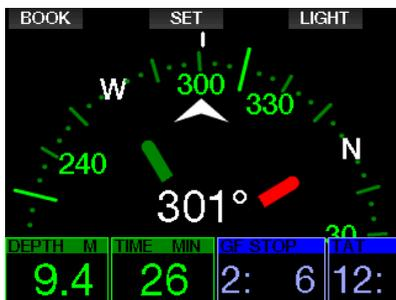
Pressionar e segurar o botão direito da tela da bússola retorna à tela do computador. Isso também acontece após a configuração do tempo para desligamento automático definido no capítulo **Tempo para desligamento automático**.
