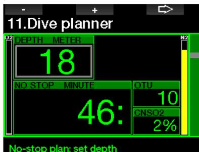
Os valores de CNS% e da OTU aparecem na tela quando for atingido 1% dessa profundidade com o tempo máximo sem paradas (no-stop).
