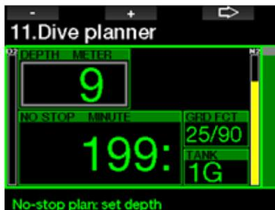
Quando for dado o intervalo de superfície, ou se você não tiver nenhuma dessaturação restante, o planejador pode mostrar a profundidade em incrementos de 3 m/10 pés. O tempo de mergulho sem descompressão é mostrado para essa profundidade.
