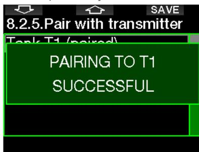
**NOTA:** O transmissor deve ter sido despressurizado durante pelo menos 40 segundos anteriormente à operação de pareamento; caso contrário, não transmitirá a sequência de pareamento.
