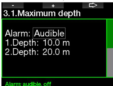
Após a ativação do alarme de profundidade máxima, os limites podem ser selecionados. O primeiro alarme de profundidade pode ser selecionado a partir de 5-100 m/20-330 pés.
