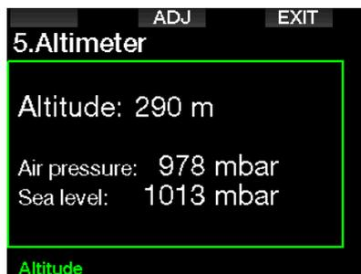
☞ **NOTA:** A pressão barométrica é variável, mudando com a meteorologia e a pressão atmosférica em uma determinada elevação. Os algoritmos de mergulho utilizam classes de altitude que derivam diretamente da pressão atmosférica. A altitude mostrada é determinada a partir da pressão barométrica atual, sendo, portanto, um valor relativo.
