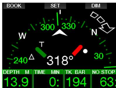
Se você tiver definido um rumo de referência, aparecerão setas à esquerda ou à direita da indicação numérica do rumo, para mostrar em qual direção você deve virar para corresponder ao rumo definido. Como um auxílio adicional na navegação, o G2TEK marca automaticamente as posições a 90 e 120 graus à esquerda e à direita do rumo definido, além da posição a 180 graus (para auxiliar nos percursos quadrado, triangular e inverso/bilateral). Estes são indicados com "T", Δ e ∥.
