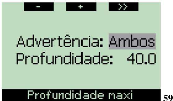
Durante o mergulho, se descer abaixo da profundidade ajustada e o aviso estiver configurado para **VISUAL** ou **BOTH**, o Galileo mostrará a mensagem **MAX DEPTH REACHED** durante 12 segundos em vez da informação no-stop ou descompressão.
