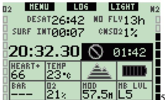
Não deve mergulhar até que o aviso No-Dive permaneça no visor do computador. Se o aviso for accionado pela acumulação de micro bolhas (em vez de CNS O2 acima de 40%) e mergulhar, vai ter um limite não descompressivo ajustado muito curto ou longo tempo de descompressão. Para além disso, a duração do aviso de micro bolhas, no final do mergulho, aumenta consideravelmente.
