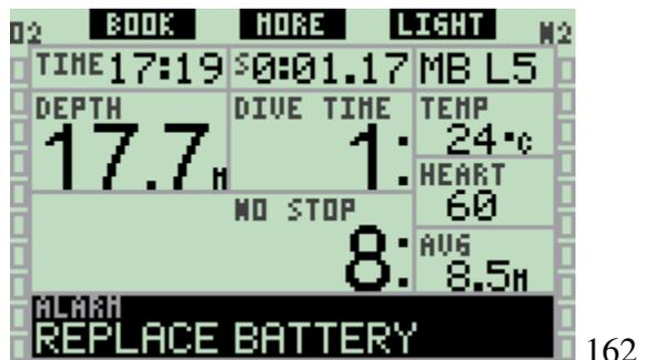
Para além de monitorar o estado da sua própria bateria, o Galileo também monitora o estado da bateria dos transmissores T1, T2 e TD e alerta-o quando a bateria está fraca e deve ser substituída. A mensagem **T1** (ou **T2** ou **TD**) **BATTERY LOW** é exibida na linha do meio do visor em intervalos de 4 segundos. Na configuração **LIGHT**, o visor muda para **CLASSIC** para permitir que toda a informação relevante seja exibida.
