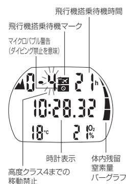
ダイビング終了後、5分経過すると、本製品は時計表示画面に戻り、飛行機搭乗待機時間、マイクロバブル警告(該当した場合)、現在の高度クラスと移動限界高度を表示します。→ P29
