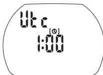
SCUBAPRO UWATEC JAPAN で出荷時に、日本標準時(UTC + 9)に設定されています。旅行などで時差のある国へ出かけた時には、旅先の標準時(日本なら + 9 のように UTC (協定世界時)を基準とした UTC との時差)を設定すれば、旅先の時刻へ設定変更でき、日付も連動し変更されます。また再度日本時刻へ戻す場合は、UTC を日本標準時 + 9 に設定すれば日本時刻が表示されます。
