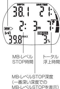
MB-レベルSTOP 域に入ると“NO STOP”が消え、代わりに矢印の[STOP]が現れます。[STOP]が 8 秒間点滅し、注意音が鳴ります。MB-レベルを変更すること無くこのダイビングを終了するためには、指示されるすべての MB-レベルSTOP を守らなければなりません。一番深い MB-レベルSTOP 深度がメートルで表示されます。2 図の(2:30 m)は、3 m の深度で 2 分の MB-レベルSTOP がアドバイスされたことを示しています。LO と関連する減圧情報は他のディスプレイで表示されます(参照)。この MB-レベルSTOP が守られた後、必要であれば次の段階の MB-レベルSTOP を表示します。すべての MB-レベルSTOP が終了すると、[STOP]は消え、“NO STOP”が再び現れます。
