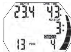
浮上中のダイバーが PDIS 深度に達するときに Aladin 2G が減圧義務を表示する場合にも同様のルールが当てはまりますが、2 分のカウントダウンはバックグラウンドで行われ、画面には表示されません。ただしダイバーが PDIS の範囲内にいることを伝えるため、PDIS の標識は点滅します。
