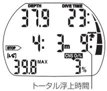
MB-レベルSTOP 情報とトータル浮上時間を表示します。このトータル浮上時間は、すべての MB-レベルSTOP 時間を含めた水面に到達するまでの浮上にかかる時間です。
