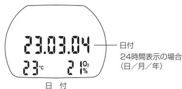
時計表示画面から、1回か2回(体内残留窒素排出時間が残っているかどうかによる)○●を押すと、日付が表示されます。
