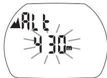
基準となる現在地の高度を設定し、移動時などの高度を計測・表示する機能です。
