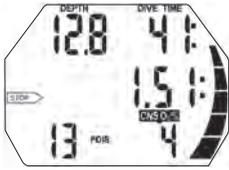
MBレベルにより潜水する場合にもPDISは上記と同じルールに従います。ただしMBレベルはLOベースアルゴリズムより早く深く停止を導入します。このためPDIS表示が遅れることがあり、潜水によってはまったく表示されないこともあります。例えば空気(21%酸素)とMBレベルL5による浅い潜水がこれに該当します。
