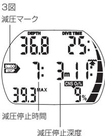
減圧ダイビング域に入ると、〈NO STOP〉が消え、**DECO STOP** マークが表示され、注意音が鳴ります。体内窒素量バークラフは点滅を止め、6番目のブロックが点灯します。(レッドエリア) **DECO STOP** マークの横には、減圧停止をしなければならない減圧停止時間が分単位で、その横に深度がメートル表示されます。3 図の〈7 : 3m〉の場合は、深度 3m で 7 分間の減圧停止をしなければならないということです。
