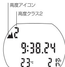
本製品は休息モード中でも、60秒ごとに大気圧を計測しています。そのためコンピュータが高度クラスの変化を感じると自動的にサーフェイスモードになり、新しい高度クラス(1~4)と体内残留窒素排出時間を表示します。この時の体内残留窒素排出時間は、この高度の環境に身体が順応する時間(高所潜水順応時間)をさしています。もし高所潜水順応時間経過前にダイビングを始めると、コンピュータは反復潜水とみなし、その時間を考慮したダイブプランとダイビングプログラムを演算します。すべての高度クラスは、気象学的な状況を考慮した上で5つのグループに分かれています。そのため、前後のグループでオーバーラップする部分があります。高所潜水の高度に達すると、その高度のクラスはサーフェイス(時計表示画面)、ログブック、ダイブプランの各モードに、マークとそのクラスの数値が表示されます。海水面からほぼ1000mまでは表示されません。およそ5つの高度クラスグループは次のとおりです。
