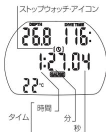
本製品は、ゲージモードで水中に入ると、潜水時間を自動的にモニターすると同時に、ストップウォッチとして機能します。ストップウォッチは最大で 24 時間作動します。
