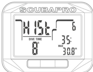
上の例では、最大深度が30.8mで、最長潜水時間は35分間です。このコンピュータでの合計潜水時間は8時間、合計本数は6本です。履歴を消すことはできません。右または左ボタンを押して、記録されたダイビングを順にスクロールできます。
