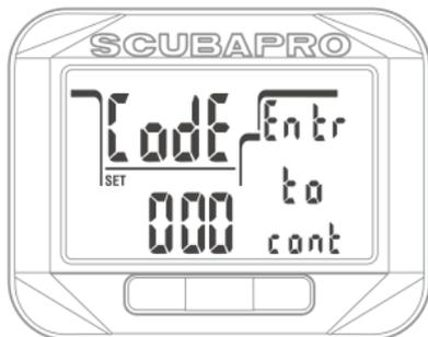
テキストコード(「Enter to continue」)が表示され、コードの最初の数字が点滅を始めます。右または左ボタンを押して数字を変更し、右長押し(SEL)を押して確定します。すると、隣の数字が点滅を始めます。サウンドオフの解除コードは「313」です。
