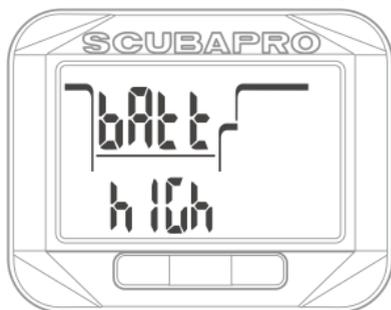
バッテリーステータスメニューは、CR2450バッテリーの残量を示します。新しいバッテリーでは「high」と表示されます。
