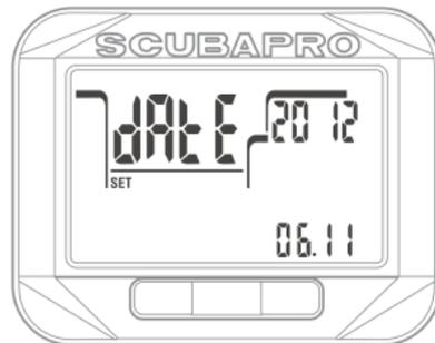
日付メニューで右長押し(SEL)を押すと、日/月フィールドの最初の2桁が点滅を始め、右または左ボタンを押して変更することができます(24hモードでは最初の桁は日ですが、12hモードでは月です)。右長押し(SEL)を押して設定を確定すると、次の2桁が点滅を始めます。ここでも、右長押し(SEL)を押すと設定が確定し、年が点滅を始めます。右または左ボタンを押して、年を変更できます。右長押し(SEL)を押すと、年が確定します。
