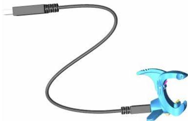
SquareとSharkの間の通信は、ケース底面の接触部で行われます。そのため、クレードルの水接点またはスプリング接点の表面に汚れがある場合は、使用前に布で拭いてください。
