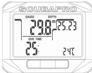
ゲージモードでは、平均深度をリセットできます。平均深度をリセットするには、**右ボタンを長押し**します。
