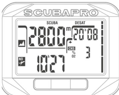
『NO DIVE』シンボルがコンピューター画面に表示されている場合は、ダイビングを行わないでください。（CNS O<sub>2</sub>が40%を超えたことではなく）マイクロバブルの蓄積によりこの警告が発生し、この警告を無視してダイビングを行うと、無減圧限界時間が短くなるか、減圧停止時間が長くなります。さらに、ダイビング終了時のマイクロバブル警告の発生時間が大幅に長くなります。
