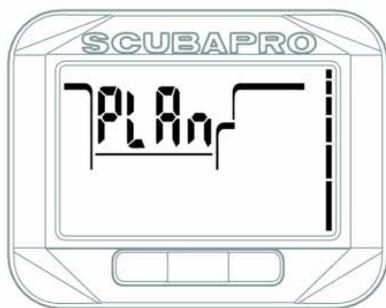
体内残留窒素量に基づいて次回のダイブプランを作成できます。プランナーは、次の情報も計算に使用します。
