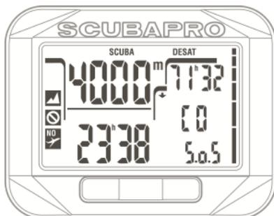
画面には、体内残留窒素があるときと同じ情報が表示されます。ただし、右下には「SOS」が点滅します。
