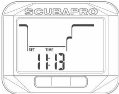
時刻設定メニューでは、メニューに現在時刻が表示されます。右長押し(SEL)を押すと、時刻設定がアクティブになり、時間が点滅を始めます。時間は、右または左ボタンを押して変更できます。右長押し(SEL)を押すと分が点滅を始め、右または左ボタンを押して変更できます。右長押し(SEL)を押すと、新しい時刻が設定されます。
