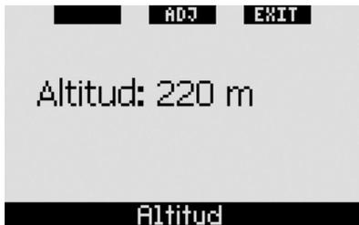
Para configurar la altitud, **pulse ADJ** para entrar en el menú **AJUSTAR ALTITUD**. Una vez dentro de este menú, utilice los botones + o - para llegar al valor de altitud deseado. Cada vez que **pulse +** o **-**, la altitud visualizada cambiará con incrementos de 10 m. **Pulse SAVE** para confirmar su selección y regresar al menú principal del **Altímetro**.
