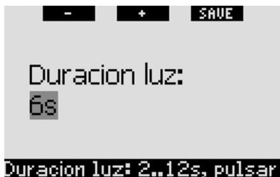
En el modo superficie, la luz sólo se puede activar desde la pantalla de la **hora**, cuando el botón de la derecha presenta la indicación **LIGHT**. En el modo superficie, la luz tiene una duración de 1 minuto, tras el cual se apaga automáticamente, proporcionándole tiempo suficiente para navegar por los menús y realizar cambios en las configuraciones. Puede apagarla en cualquier momento **pulsando** de nuevo el botón **LIGHT**.
