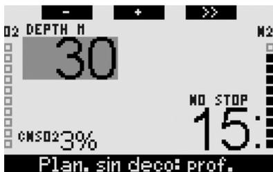
**Pulse >>** en cualquier momento para pasar al planificador de inmersiones fuera de la curva de seguridad para la profundidad indicada. Galileo añadirá un minuto al tiempo sin paradas y mostrará la descompresión obligada resultante.
