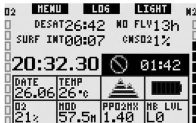
No debe realizar ninguna inmersión hasta que el mensaje de advertencia “no-dive” desaparezca de la pantalla del ordenador. Si la advertencia ha sido activada por la acumulación de microburbujas (y no por un nivel de CNS O<sub>2</sub> superior al 40%) y realiza una inmersión, tendrá tiempos sin parada más cortos o tiempos de descompresión más largos. Además, la duración de la advertencia por microburbujas puede aumentar considerablemente al final de la inmersión.
