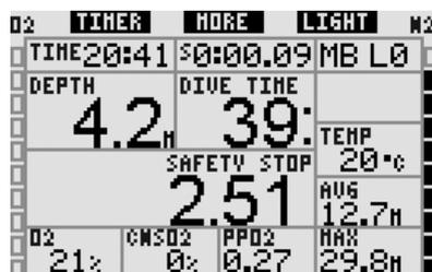
En el modo brújula, el temporizador de parada de seguridad funciona de la misma forma que en las configuraciones **CLASSIC**, **LIGHT** y **FULL**. Si el temporizador de parada de seguridad está activo cuando se pasa de una configuración a otra, la información del temporizador pasará de una pantalla a otra.
