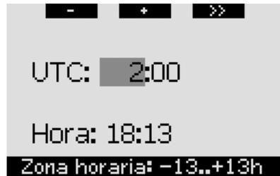
El intervalo de la configuración UTC va de -13 horas a +13 horas, con incrementos de 15 minutos.
