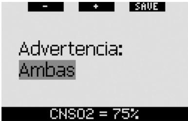
Si una advertencia está configurada en **VISUAL** o **AMBAS** y se activa con Galileo en modo brújula, la pantalla cambiará automáticamente a la configuración normal (**CLASSIC**, **LIGHT** o **FULL**) para mostrar correctamente el mensaje de advertencia.
