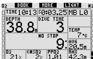
Galileo también tiene un modo de profundímetro, con su correspondiente configuración **GAUGE**, en la que el ordenador actúa como un profundímetro digital y no realiza ningún cálculo de descompresión.
