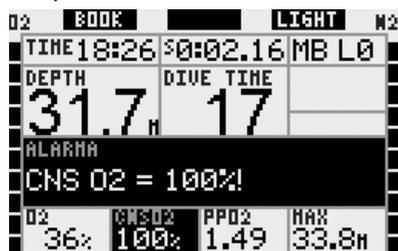
En todas las configuraciones, el mensaje de alarma y la señal sonora se repetirán durante 5 segundos en intervalos de un minuto tras la primera detección y mientras el valor de CNS O<sub>2</sub> permanezca en o por debajo del 100% o hasta que la ppO<sub>2</sub> descienda por debajo de 0,5 bares (en el apartado 3.1, encontrará una lista de profundidades en las que la ppO<sub>2</sub> es igual a 0,5 bares para mezclas habituales de Nitrox).
