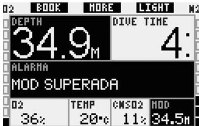
En la configuración **LIGHT**, el mensaje de alarma **MOD SUPERADA** se muestra en lugar de la información de la inmersión sin parada durante 12 segundos, transcurridos los cuales se repetirá en intervalos de 4 segundos. Además, la profundidad actual se muestra con contraste de colores (blanco sobre fondo negro) y permanece así hasta que el submarinista ascienda 1 m por encima de la MOD. La señal sonora no cesará hasta que el submarinista ascienda 1 m por encima de la MOD.
