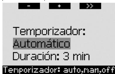
Si, durante el proceso de modificación de una configuración, el ordenador no recibe ninguna entrada durante 3 minutos, pasará automáticamente a la visualización de la hora sin guardar ningún cambio.
