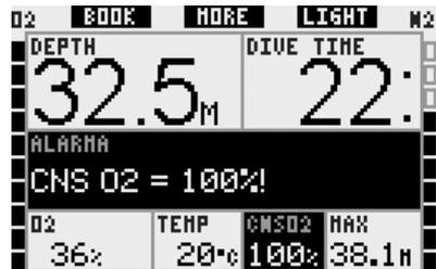
En la configuración **LIGHT**, en lugar de los datos de la inmersión sin parada, se mostrará el mensaje de alarma **CNS O<sub>2</sub> = 100%** durante 12 segundos y la señal sonora se desactivará durante este tiempo. Además, una vez desaparezca el mensaje de texto, el CNS O<sub>2</sub> se mostrará en el ángulo inferior izquierdo con contraste
