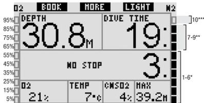
**Gráfico de barras del nitrógeno:** está situado en la parte derecha de la pantalla (en las configuraciones **CLASSIC**, **LIGHT** y **FULL**). Representa la saturación de nitrógeno en el compartimento del tejido principal. El gráfico de barras está formado por diez segmentos. Los primeros nueve segmentos representan gradualmente una mayor carga, pero permanecen dentro de la inmersión sin paradas; el décimo segmento representa la necesidad de una parada de descompresión obligatoria.
