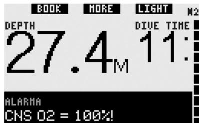
En la configuración **FULL**, en lugar de la información sobre la inmersión y las paradas o fuera de la curva de seguridad, se muestra el mensaje de alarma **CNS O<sub>2</sub> = 100%** durante 12 segundos y la señal sonora se desactiva durante este tiempo. Además, la información del CNS O<sub>2</sub> se mostrará con contraste de colores (blanco sobre fondo negro) hasta que su valor disminuya por debajo del 100%.
