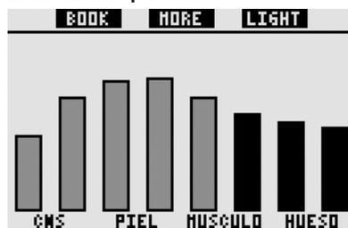
Si ha cargado imágenes en Galileo, podrá verlas durante la inmersión **pulsando MORE** durante la visualización de la saturación de los compartimentos. Cada vez que **pulse MORE** durante la visualización de una imagen, se mostrará la siguiente imagen en la secuencia de la memoria de Galileo. Las imágenes sólo permanecerán en la pantalla durante un máximo de 12 segundos. Puede regresar a la pantalla del ordenador de buceo en cualquier momento **manteniendo pulsado** el botón derecho.
