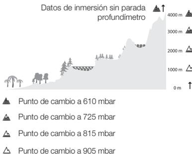
Galileo procesa la altitud automáticamente: monitoriza la presión atmosférica cada 60 segundos, incluso cuando está apagado, y si detecta una caída de presión suficiente, hace lo siguiente:
