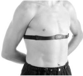
Der codierte Sender Polar 31 ist mit einer Batterie mit einer ungefähren Betriebsdauer von 2500 Stunden ausgestattet. Der Sender wird durch Feuchtigkeit aktiviert. Wenn er z. B. auf ein feuchtes Badetuch gelegt wird, verbraucht er Batterieenergie. Wenn Sie annehmen, dass die Batterie leer ist, wenden Sie sich bitte an ein autorisiertes Polar Service Center, um den Sender ersetzen zu lassen. Polar führt gebrauchte Sender der Wiederverwertung zu.
