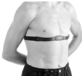
Il trasmettitore codificato T31 Polar è dotato di una batteria con durata di circa 2500 ore. Il trasmettitore viene attivato dall'umidità, quindi lasciandolo ad esempio su un asciugamano bagnato si continua a consumare la batteria. Se si ritiene che la batteria sia esaurita, rivolgersi al centro assistenza autorizzato Polar di zona per la sostituzione del trasmettitore. Polar ricicla i trasmettitori esauriti.
