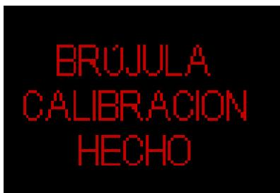
☞ **NOTA:** La brújula de HUD no suele requerir ninguna calibración. No obstante, si advierte una desviación permanente significativa en la dirección de la brújula, realice el procedimiento de calibración.
