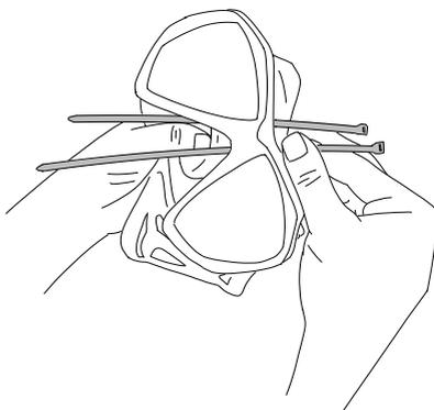
Deslice una brida hacia abajo por el lado izquierdo del alojamiento para la nariz y la otra por el lado derecho. Una vez que haya finalizado, compruebe que las bridas estén correctamente colocadas.
