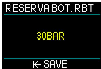
El tiempo remanente en el fondo (RBT, por sus siglas en inglés) es el tiempo que puede permanecer en la profundidad actual manteniendo un suministro de gas suficiente para realizar un ascenso seguro y llegar a la superficie con la reserva de la botella.
