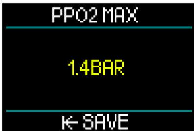
El ajuste de la ppO<sub>2</sub> máx define el límite de la presión parcial de oxígeno. Es la misma para todos los gases. HUD ofrece ajustes de ppO<sub>2</sub> máx de 1,3 bar a 1,6 bar (el valor predeterminado es 1,4 bar).
