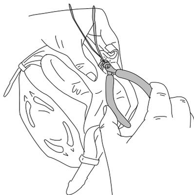
**NOTA:** Si necesita sustituir alguna brida, utilice bridas de 3,5x200 mm (0,14x8 in).
