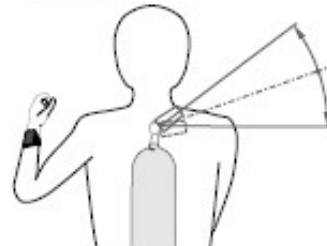
Position de l'émetteur pour les gauchers, s'il n'est pas possible de le connecter sur la gauche.
