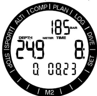
Durante um mergulho no modo GAUGE, o M2 exibe um cronômetro na linha de fundo. O cronômetro pode ser parado pressionando o botão -/DOWN o botão. Quando o cronômetro é parado, pode ser resetado e reiniciado, pressionando-se e segurando o botão -/DOWN. Enquanto estiver no modo GAUGE, a profundidade média pode ser resetada. Para reiniciar a profundidade média, pressione e segure o botão +/UP.
