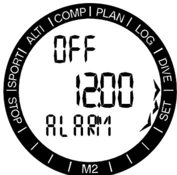
Pressionando-se o botão SEL, o estado do alarme vai começar a piscar e pode ser ligado ou desligado, pressionando-se os botões +/UP ou -/DOWN. Ao pressionar o botão SEL as horas do alarme começarão a piscar. Você pode rolar a configuração de horas, pressionando os botões +/UP ou -/DOWN. Ao pressionar o botão SEL os minutos começarão a piscar e pressionando os botões +/UP ou -/DOWN pode rolar com eles. Pressionando o botão SEL confirmará as configurações.
