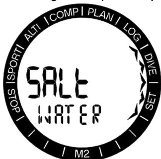
M2 determina a profundidade através da medição da pressão usando a densidade da água, como uma constante. A profundidade de 10m/33pés na água salgada corresponde aproximadamente à 10,3m/34pés em água doce.
