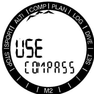
Pressionando-se o botão SEL, a bússola é ativada e mostra a direção do rumo (posição de 12 horas no relógio) na linha intermédia em graus. A direção do Norte está indicada por uma seta no anel graduado.
