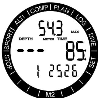
Depois de um mergulho, a exibição do modo GAUGE de superfície mostra o tempo de mergulho na linha do meio. Na linha de fundo, o cronômetro está funcionando desde o início do mergulho ou última reinicialização manual. Na linha superior a profundidade máxima de mergulho é exibida. Após um tempo de operação de 5 minutos, o visor passa para o menu do modo GAUGE.
