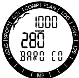
Pressionando e segurando o botão -/DOWN o visor muda, mostrando agora a pressão barométrica ao nível do mar na linha superior. Ou então, pressionando-se o botão +/UP se pode obter a pressão barométrica na altitude atual em mbar. Este recurso do Barômetro permite a você prever o tempo se aproximando nas próximas horas se a sua altitude permanece a mesma.
