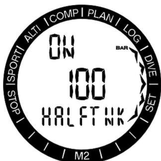
Ao pressionar-se o botão SEL, o status ligado/desligado pisca. Selecione o modo, pressionando o botão +/UP. Pressionando-se SEL, o valor de pressão começa a piscar e você poderá ajustar um valor entre 50 bar e 200 bar em incrementos de 5 bar (749..2999
