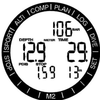
Uma vez que a profundidade PDIS foi alcançada, você deve ficar na zona que tem + 0,5 m..+3,0m/- 2 pés..-10 pés da profundidade PDIS mostrada. Se você descer abaixo dessa zona a contagem PDIS será desativada e o M2 calcula uma nova profundidade PDIS.
