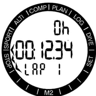
As voltas podem ser marcadas pressionando o botão -/DOWN quando o cronômetro está contando. Ao fazer isso, a tela congela por 5 segundos e o M2 mostrará o tempo de volta. A contagem continuará automática e o contador de volta mostrará o número de voltas na parte inferior da tela.
