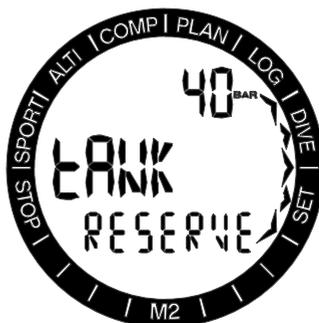
Pressionando-se SEL, o valor de pressão começa a piscar e você pode ajustar um valor entre 20 bar e 120 bar em incrementos de 5 bar (299..1749 psi em incrementos de 50 psi), pressionando os botões +/UP ou -/DOWN. Pressionando o botão SEL confirma as configurações.
