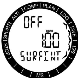
Pressionando-se o botão SEL neste menu, a função começa a piscar e poderá ativar ou desativar o alarme, selecionando on/off (ligado ou desligado) com os botões +/UP ou -/DOWN. Após ter confirmado a sua seleção pressionando o botão SEL, o tempo do intervalo de superfície começa a piscar. Ao pressionar +/UP ou -/DOWN você pode selecionar o intervalo entre 15 segundos até 10 minutos. Ao pressionar SEL novamente a seleção será confirmada.
