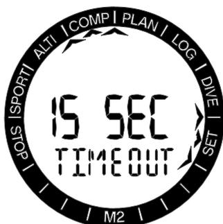
O tempo de operação da bússola é a quantidade de tempo em que a bússola é visualizada quando está ativada. O tempo de operação da bússola é válido para a visualização da bússola em todos os modos: Mergulho, Esporte, etc. Ajuste a configuração para o tempo de operação, pressionando o botão SEL e deslizando pelos valores, pressionando os botões +/UP ou -/DOWN entre 5, 10, 15, 30, e 60 segundos, ou PUSH (liga/desliga). Ao pressionar o botão SEL o valor será confirmado.
