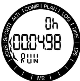
Pressione o botão +/UP e o cronômetro começa a contar e mostra estado real que é: run. Pressionando novamente o botão +/UP cronômetro para a contagem e mostra o estado atual: stop. O tempo contado permanece na tela.
