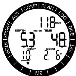
Em caso de presença de uma descompressão necessária impedindo de subir mais de 0,5m/2 pés acima da parada necessária, o M2 irá acionar um alarme: o valor da profundidade atual e o valor da profundidade da parada necessária piscará, e uma sequência de apitos pode ser ouvida. Isso vai continuar durante o tempo que você ficar 0,5m/2 pés ou mais acima da parada necessária.
