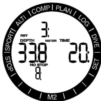
Quando o RBT atinge os 0 minutos, é ativado um alarme: o M2 calculou que se começar a subir agora a uma velocidade de subida ideal, chegará à superfície apenas com a reserva, pelo que qualquer atraso vai aumentar o risco que você corre de ficar sem o fornecimento de gás antes de atingir a superfície.
