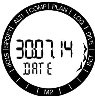
Pressionando-se o botão SEL, os primeiros dois dígitos da data começam a piscar. No modo 24 horas, os primeiros dígitos representam o dia, no modo de 12 horas, representam o mês. Você pode alterar a configuração pressionando os botões +/UP ou -/DOWN. Ao pressionar o botão SEL os próximos dígitos começam a piscar e eles podem então ser editados pressionando botão +/UP ou -/DOWN. Pressionando-se novamente os botões SEL, o ano começa a piscar. Pressionando-se o botão SEL, a data ficará confirmada.
