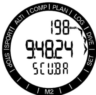
Após a imersão, o M2 iniciará automaticamente a monitorar o mergulho, independentemente do estado em que estava antes da imersão. Os detalhes sobre as informações exibidas podem ser encontrados nas seções seguintes.
