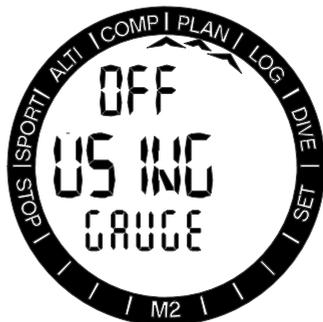
Ao pressionar o botão SEL no menu planejador você vai entrar no planejador diretamente ou na definição do intervalo de superfície após o mergulho repetitivo.
