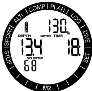
O M2 também fornece um alarme sonoro no caso de as taxas de subida excederem a 110%: a intensidade dos aumentos de alarme em proporção direta com o grau em que a velocidade de subida ideal é ultrapassada.
