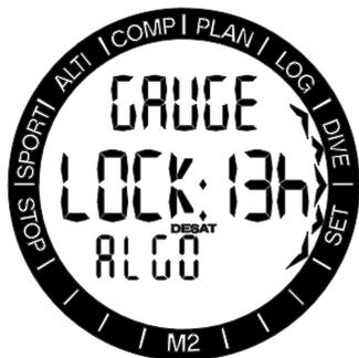
A mudança para o modo GAUGE ou APNEA é possível após o tempo de dessaturação do último mergulho em SCUBA se ter esgotado.
