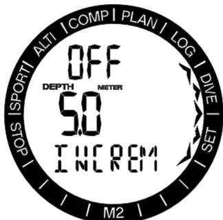
Ao pressionar o botão SEL neste menu o modo incremental começa a piscar. Ao pressionar os botões +/UP ou -/DOWN, poderá navegar através dos valores do alarme ou desativá-lo com as seleções a seguir: off, dn (para baixo), up (para cima), ou ambas. Após confirmar a seleção com o botão SEL o alarme de profundidade começa a piscar. Ao pressionar os botões +/UP ou -/DOWN você pode selecionar o valor do alarme de 5 a 100 m (20..330 pés). Ao pressionar o botão SEL o valor do alarme será confirmado.
