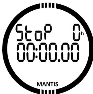
Durch Drücken des +/UP Knopfs startet die Stoppuhr und zeigt den aktuellen Status „run“ an. Durch erneutes Drücken des +/UP Knopfs stoppt die Stoppuhr und zeigt den aktuellen Status „stop“ an. Die gemessene Zeit bleibt auf der Anzeige.
