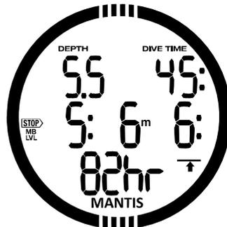
Wenn Sie ein MB-Level von mehr als L0 eingestellt haben, und eine geringere Tiefe als den tiefsten erforderlichen MB-Level-Stopp erreichen, wird diese Warnung aktiviert. MANTIS gibt eine Sequenz von Signaltönen aus und das MB-Level-Stoppssymbol, die MB-Level-Tiefe und die MB-Level-Zeit blinken während 12 Sekunden.
