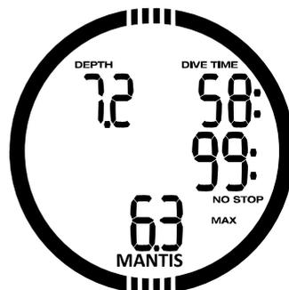
Wenn Sie nach dem Wechsel zu Gas d oder Gas 2 unbeabsichtigt wieder unter die MOD für dieses Gemisch tauchen, wird sofort der MOD-Alarm ausgelöst. Wechseln Sie entweder zurück zu Gas 1 oder tauchen Sie über die MOD von Gas d oder Gas 2 auf.
