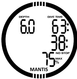
MANTIS kontrolliert Ihre Sauerstoffaufnahme über die CNS O<sub>2</sub> Uhr. Wenn der berechnete CNS O<sub>2</sub> Wert 75 % erreicht, gibt MANTIS eine Sequenz von akustischen Signaltönen von 12 Sekunden aus und das %-Symbol blinkt in der Ecke oben rechts. Die Anzeige blinkt, bis der CNS O<sub>2</sub>-Wert unterhalb von 75 % fällt.
