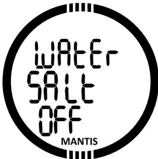
MANTIS ermittelt die Tiefe durch das Messen des Wasserdrucks, wobei er die Wasserdichte als Konstante berücksichtigt. 10 m/33 ft. Tiefe in Salzwasser entsprechen 10,3/34 ft. in Süßwasser.
