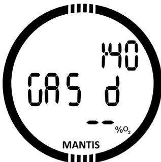
Sehen Sie das Kapitel **Tauchen mit zwei oder mehr Gasgemischen** für mehr Informationen über die Verwendung von Gas 2 und d. Einstellen Gas d oder Gas 2 sind ähnlich wie für Gas 1. Gas 2 kann nur eingestellt werden, wenn Gas d aktiviert und eingestellt ist.
