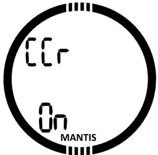
Durch Drücken von SEL auf diesem Display wird der CCR-Modus aktiviert oder deaktiviert und kann durch Drücken von +/UP oder -/DOWN ausgewählt werden. Durch Drücken von SEL wird die Einstellung bestätigt.
