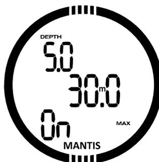
Durch Drücken des Knopfs SEL in diesem Menü, beginnt der erste Tiefenwert zu blinken. Durch Drücken von +/UP oder -/DOWN können Sie den ersten Tiefenalarm zwischen 5 und 100 Meter (20 - 330 Fuß) einstellen. Durch Drücken von SEL wird der erste Wert bestätigt und die zweite Tiefe beginnt zu blinken. Wie bei der ersten Tiefe kann der zweite Tiefenalarm durch
