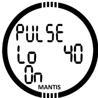
Durch Drücken von SEL in diesem Menü, beginnt der Wert HR low (Puls tief) zu blinken. Durch Drücken von +/UP oder -/DOWN können Sie von 25 Spm bis zu 100 Spm durch die Werte blättern. Durch Drücken von SEL in diesem Menü beginnt die Funktion zu blinken und mit +/UP oder -/DOWN können Sie den Alarm aktivieren (on) oder deaktivieren (off). Durch Drücken des Knopfs SEL wird die Auswahl bestätigt.
