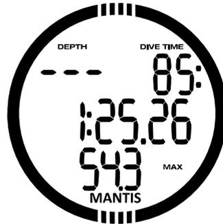
Nach einem Tauchgang zeigt die Oberflächenanzeige des Gauge-Modus die Tauchzeit auf der oberen Zeile an. In der mittleren Zeile läuft die Stoppuhr ab Beginn des Tauchgangs oder ab letztem manuellen Neustart. Auf der unteren Zeile wird die maximale Tiefe angezeigt. Nach 5 Minuten wechselt das Display auf den GAUGE-Menümodus.
