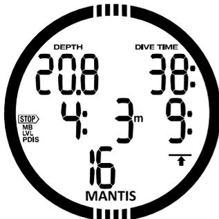
Nachdem die PDIS-Tiefe erreicht worden ist, sollten Sie in einem Bereich von +0,5 bis -3,0m/ +2ft. bis -10ft. um die angezeigte PDIS-Tiefe verweilen. Wenn Sie unterhalb dieses Bereichs abtauchen, wird der PDIS-Zähler deaktiviert und MANTIS berechnet eine neue PDIS-Tiefe.
