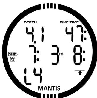
Wenn Sie einen höheren MB-Level als L0 eingestellt haben und Sie mehr als 1,5 m über den erforderlichen MB-Level-Stopp auftauchen oder Sie bleiben nach dem Ignorieren einer MB-Level-Warnung auf einer geringeren Tiefe, wird der MANTIS Ihr MB-Level auf das nächsttiefere Level senken. Der akustische Signalton wird während 12 Sekunden aktiviert und der neue MB-Level blinkt auf der unteren Zeile bis zum Ende des Tauchgangs.
