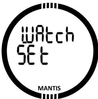
Durch einmaliges Drücken des Knopfs - / DOWN auf dem Hauptzeit- und Datums-Display und durch Auswählen des Menüs „SET“ über den Knopf SEL öffnet sich des Uhreinstellmenü (auf der folgenden Tabelle dunkel dargestellt).
