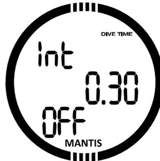
Durch Drücken von SEL in diesem Menü beginnt die Zeit zu blinken. Durch Drücken von +/UP oder -/DOWN können Sie das Intervall zwischen 15 und 10 Minuten einstellen. Durch Drücken des Knopfs SEL beginnt die Funktion zu blinken und Sie können sie über +/UP oder -/DOWN aktivieren (on) oder deaktivieren (off). Durch Drücken des Knopfs SEL wird die Einstellung bestätigt.
