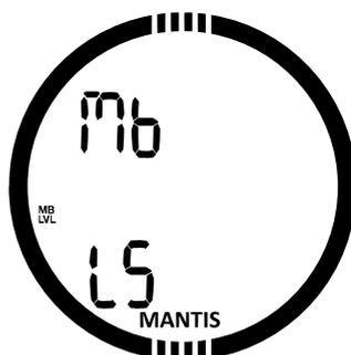
Durch Drücken des Knopfs SEL in diesem Menü, beginnt der Mikroblasenlevel zu blinken. Durch Drücken von +/UP oder -/DOWN können Sie eine persönliche Einstellung von L0 bis L5 auswählen wobei L5 die konservativste Einstellung ist. Diese Auswahl wird über den Knopf SEL bestätigt.
