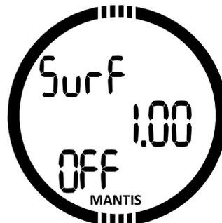
Durch Drücken von SEL in diesem Menü beginnt die Oberflächen-Intervallzeit zu blinken. Durch Drücken von +/UP oder -/DOWN können Sie von 15 Sekunden bis zu 10 Minuten durch die Werte blättern. Durch Drücken des Knopfs SEL beginnt die Funktion zu blinken und Sie können den Alarm über +/UP oder -/DOWN aktivieren (on) oder deaktivieren (off). Durch erneutes Drücken des Knopfs SEL wird die Auswahl bestätigt.
