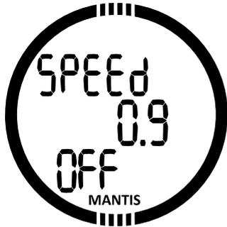
Durch Drücken von SEL in diesem Menü beginnt die Aufstiegs geschwindigkeit zu blinken. Durch Drücken von +/UP oder -/DOWN können Sie den Wert zwischen 0,1 und 5,0 Meter (1 - 15 Fuß) einstellen. Durch Drücken des Knopfs SEL wird der Wert bestätigt und die Funktion beginnt zu blinken. Durch Drücken von +/UP oder -/DOWN können Sie den Alarm aktivieren (on) oder deaktivieren (off). Durch Drücken des Knopfs SEL wird die Auswahl bestätigt.
