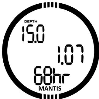
In der mittleren Zeile zählt der Oberflächen-Intervallzähler bis 15 Minuten. Wenn kein Wiederholungstauchgang durchgeführt wird, zeigt MANTIS wieder das APNÖE-Menü an.
