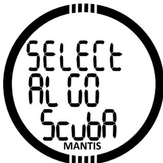
Die Modi GAUGE und APNÖE führen keine Gewebesättigungs-Berechnungen durch. Anschließend an diese Modis folgt ein Sperrintervall, bevor auf den SCUBA-Modus gewechselt werden kann. Im GAUGE-Modus beträgt das Sperrintervall 48 Stunden nach dem letzten Tauchgang im GAUGE-Modus. Im APNÖE-Modus beträgt das Sperrintervall bei Tauchgängen von weniger als 5 m/16 ft. 12 Stunden bei tieferen Tauchgängen als 5 m/16 ft. 24 Stunden nach dem letzten Tauchgang im APNÖE-Modus.
