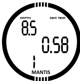
Durch Drücken von +/UP oder -/DOWN kann durch die Tauchgänge der aktuellen Serie geblättert werden.
