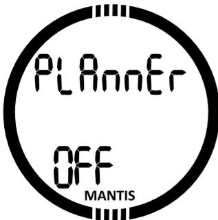
Durch Drücken des Knopfs SEL im Planer-Menü öffnen Sie direkt den Planer oder nach einem Wiederholungstauchgang die Einstellungen des Oberflächenintervalls.
