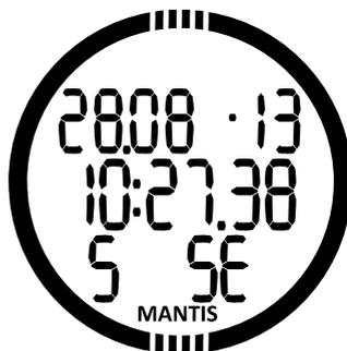
Das Logbuch wird die Startzeit und das Datum auf der Hauptseite anzeigen. Durch Drücken von SEL (siehe Display unten) können Sie die zurückgelegte Distanz (1238 m), die Trainingszeit (38 Minuten, 53 Sekunden) und den durchschnittlichen Pulsschlag (128 Schläge/Minute) einsehen.
