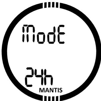
Durch Drücken des Knopfs SEL beginnt 24h oder 12h in der unteren Zeile zu blinken. Sie können durch Drücken der Knöpfe +/UP oder -/DOWN die Einstellung ändern. Durch Drücken des Knopfs SEL wird der Modus bestätigt.
