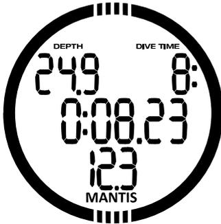
Während eines Tauchgangs im GAUGE-Modus zeigt MANTIS auf der mittleren Zeile eine Stoppuhr an. Die Stoppuhr kann durch Drücken des Knopfs -/DOWN erneut zurückgesetzt werden. Wenn die Stoppuhr gestoppt ist, kann Sie zurückgesetzt und neu gestartet werden, indem Sie den Knopf -/DOWN drücken und halten.
