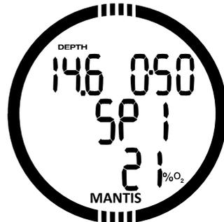
Nachdem CCR aktiviert worden ist, beginnt nach dem Drücken von SEL auf diesem Display der Sauerstoffgehalt des Verdünnungsgases zu blinken. Durch Drücken von +/UP oder -/DOWN können Sie von 21 bis 40% durch die Werte blättern. Mit SEL wird der Tankinhalt bestätigt und der Einstellwert 1 (SP1) ppO<sub>2</sub>-Wert beginnt zu blinken. Durch Drücken von +/UP oder -/DOWN können Sie von 0,3 bar bis zu 0,95 bar durch die Werte blättern. Durch Drücken von SEL werden diese Werte bestätigt.
