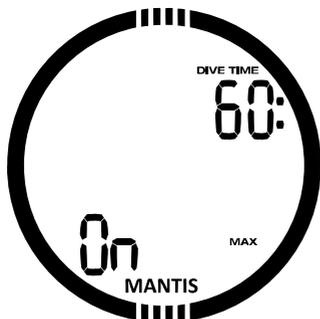
Durch Drücken des Knopfs SEL in diesem Menü, beginnt der Zeitwert zu blinken. Durch Drücken des Knopfs +/UP oder -/DOWN kann der Wert in Schritten von 5 Minuten zwischen 5 und 195 Minuten eingestellt werden. Durch Drücken des Knopfs SEL beginnt die Funktion zu blinken und Sie können über +/UP oder -/DOWN on oder off auswählen. Diese Auswahl wird über den Knopf SEL bestätigt.
