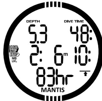
Wenn Sie bei einem Dekompressionsstopp mehr als 0,5 m /2 ft. über die erforderliche Stopptiefe auftauchen, löst MANTIS einen Alarm aus: Der Wert der aktuellen Tiefe und der Wert der erforderlichen Stopptiefe beginnen zu blinken und es wird eine Reihe von akustischen Signalönen ausgegeben. Diese werden so lange fortgesetzt, wie Sie sich 0,5 m/2 ft. oder mehr über der erforderlichen Stopptiefe befinden.
