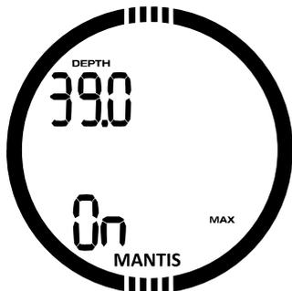
Durch Drücken des Knopfs SEL in diesem Menü, beginnt der Tiefenwert zu blinken. Durch Drücken des Knopfs +/UP oder -/DOWN kann der Wert in Schritten von 1 m (5 ft.) zwischen 5 und 100 Meter (20 bis 330 Fuß) eingestellt werden. Durch Drücken des Knopfs SEL beginnt die Funktion zu blinken und Sie können über +/UP oder -/DOWN on oder off auswählen. Diese Auswahl wird über den Knopf SEL bestätigt.
