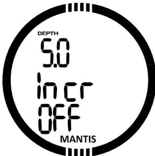
Durch Drücken des Knopfs SEL in diesem Menü, beginnt die erste Alarmtiefe zu blinken. Durch Drücken von +/UP oder -/DOWN können Sie den Alarmwert zwischen 5 und 100 Meter (20 - 330 Fuß) auswählen. Durch Drücken von SEL beginnt der Steigerungsmodus zu blinken. Durch Drücken von +/UP oder -/DOWN können Sie zwischen den Alarmrichtungen wechseln oder diese Auswahl deaktivieren: off, dn (nach unten), up (nach oben) oder beide. Durch Drücken des Knopfs SEL wird die Einstellung bestätigt.
