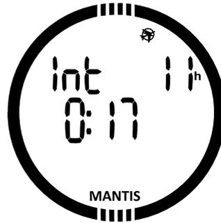
Die verbleibende CNS% wird auf der unteren Zeile und die Flugverbotszeit in Stunden auf der oberen Zeile angezeigt, bis die Einschränkung abgelaufen ist.
