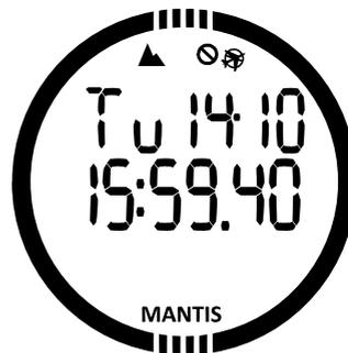
Sie sollten keinen Tauchgang durchführen, solange die No-Dive-Warnung auf dem Computerbildschirm angezeigt wird. Wird die Warnung aufgrund der Mikroblasen-Ansammlung angezeigt (im Gegensatz zum CNS O<sub>2</sub>-Stand über 40 %) und Sie tauchen trotzdem, werden die Nullzeiten verkürzt oder die Dekompressionszeiten ausgedehnt. Zudem wird die Dauer der Mikroblasen-Warnung am Ende des Tauchgangs beträchtlich verlängert.
