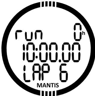
Die Intervallzeiten können durch Drücken von -/DOWN festgehalten werden, während die Stoppuhr läuft. Das Display bleibt während 5 Sekunden fix und Mantis zeigt die Intervallzeit an.
