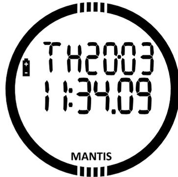
Die verschiedenen Menümodi sind auf dem Display angezeigt, zum Beispiel: „Uhreinstellung“. Jeder Modus hat weitere Unterfunktionen und Menüs. Sie können durch Drücken der Knöpfe +/UP oder -/DOWN durch die Menüs blättern. Beachten Sie, dass wenn das Menü auf dem Display angezeigt wird, dieser Modus noch nicht aktiviert ist. Durch Drücken des Knopfs SEL aktivieren Sie den angezeigten Modus und gelangen Sie in die Untermenüs.
