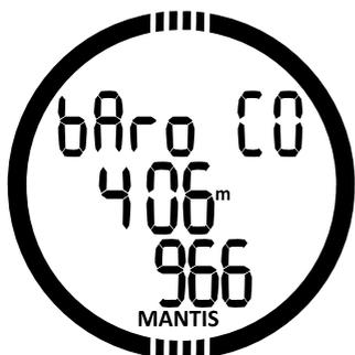
Die Höhe kann durch Drücken des Knopfs SEL angepasst werden, wenn die aktuelle Höhenlage bekannt ist. Der Höhenwert beginnt zu blinken. Durch Drücken der Knöpfe +/UP oder -/DOWN kann der Wert in Schritten von 10 m/50 ft. eingestellt werden. Die Einstellung der Höhe hat keinen Einfluss auf den Höhenbereich.
