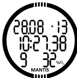
**HINWEIS:** Wenn der Tauchgang in einem der Modi GAUGE oder APNÖE oder als Oberflächentraining aufgezeichnet wurde, zeigt die Hauptseite auf der unteren Zeile GA, AP oder SE anstelle von O<sub>2</sub>% an.
