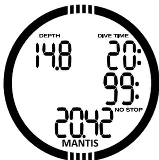
Während eines Tauchgangs beginnt der Stopp-Timer beim Eintauchen zu zählen. Wenn er während des Tauchgangs zum ersten Mal angezeigt wird, sind die Stoppzeit und die Tauchzeit identisch. Wenn angezeigt, kann der Stopp-Timer durch Drücken des Knopfs -/DOWN gestoppt werden. Dadurch wird eine Markierung gesetzt, die mit der PC/MAC Schnittstellen-Software im Logbuch eingesehen werden kann.
