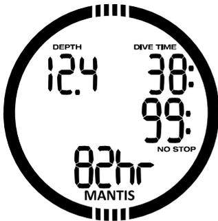
MANTIS verwendet die untere Zeile zum Anzeigen von zusätzlichen Tauchdaten. Durch Drücken des Knopfs +/UP wird folgende Sequenz angezeigt:
