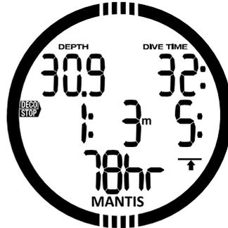
MANTIS kann eine Warnung aktivieren, wenn der erste obligatorische Dekompressionsstopp ansteht. Dadurch wird der Taucher auf die Tatsache aufmerksam gemacht, dass ein direkter Aufstieg an die Oberfläche nicht mehr möglich ist. Wenn die Nullzeit endet und ein obligatorischer Stopp erforderlich wird, bevor die Oberfläche erreicht wird, gibt MANTIS eine Sequenz von hörbaren Signaltönen aus und das Symbol DECO STOP blinkt, beides während 12 Sekunden.
