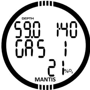
Durch Drücken des Knopfs SEL in diesem Display beginnt der Sauerstoffwert des Gases zu blinken. Durch Drücken von +/UP oder -/DOWN können Sie von 21 bis 100 % durch die Werte blättern.
