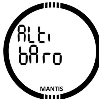
Auf dem Höhenmenü wird die aktuelle Höhe anhand des Barometerdrucks errechnet und auf der mittleren Zeile angezeigt. Die errechnete Distanz wird auf der unteren Zeile dargestellt. Der aktuelle Höhenbereich wird auf der oberen Zeile dargestellt.
