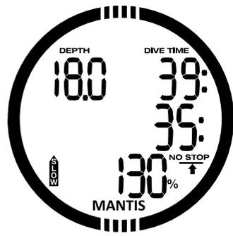
MANTIS bietet zudem einen akustischen Alarm, wenn die Aufstiegsgeschwindigkeit 110 % übersteigt: Die Intensität des Alarms nimmt in direkter Proportion mit dem Überschreiten der Aufstiegsgeschwindigkeit zu.
