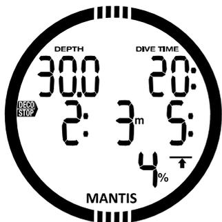
Durch Drücken von SEL für geplante Tiefen, erscheint die Tauchzeit auf der ersten Zeile. Der Startpunkt (jetzt Minimum) ist die Nullzeit. Durch Drücken der Knöpfe +/UP oder -/DOWN können Sie die Zeit in Schritten von 1 Minute verändern. Die Dekompressionszeit und die gesamte Auftauchzeit werden auf der mittleren Zeile angezeigt.
