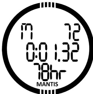
Im SWIM-Modus und während des Oberflächentrainings zeigt MANTIS die Anzahl Beinschläge oder Herzschläge auf der unteren Zeile, die verstrichene Zeit auf der mittleren Zeile und die zurückgelegte Distanz auf der oberen Zeile an.
