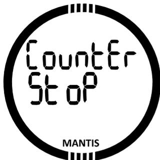
Durch Drücken des Knopfs SEL wird die Stoppuhr aktiviert: Im ersten Display wird der Status der Stoppuhr angezeigt, der die Stoppzeit, Laufzeit oder Intervallzeit sein kann. Wenn die Stoppuhr zum ersten Mal aktiviert wird, wird das Display wie unten angezeigt dargestellt.
