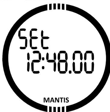
Im oben angezeigten Display wird die aktuelle Zeit auf dem Menü angezeigt. Durch Drücken des Knopfs SEL wird die Zeiteinstellung aktiviert: Stundenziffern blinken und die Sekundenziffern wechseln auf 00. Sie können die Stunden mit den Knöpfen +/UP oder -/DOWN bearbeiten. Durch Drücken des Knopfs SEL wechselt die Auswahl auf Minuten und kann verändert werden. Die neue Zeiteinstellung wird durch Drücken des Knopfs SEL bestätigt.
