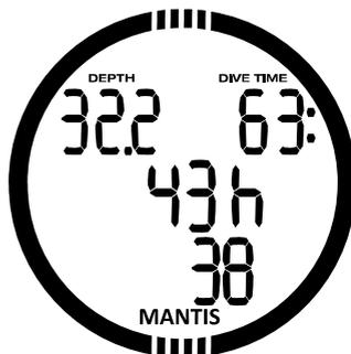
Auf oben angezeigten Display sind 38 Tauchgänge von insgesamt 43 Tauchstunden im Logbuch des MANTIS angezeigt. Der tiefste Tauchgang führte auf 32,2 Meter und der längste dauerte 63 Minuten.
