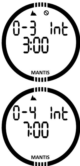
Der aktuelle Höhenbereich wird links auf der oberen Zeile und die verbotene Höhe rechts angezeigt. Im oben aufgezeigten Beispiel befindet sich der Taucher auf einem Höhenbereich 0 und darf den Höhenbereich über 3000 m (Bereich 3) während eines Zeitintervalls von 3 Stunden und 0 Minuten nicht erreichen.
