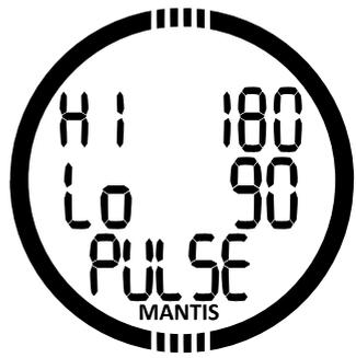
Durch Drücken von SEL in diesem Menü beginnt der maximale Puls-Wert (HI) zu blinken. Durch Drücken von +/UP oder -/DOWN können Sie das Limit zwischen 140 und 220 einstellen. Durch Drücken von SEL in diesem Menü beginnt der Basis-Puls-Wert (PO) zu blinken. Durch Drücken von +/UP oder -/DOWN können Sie das Limit zwischen 60 und 120 einstellen. Ein Basis-Puls sollte so ausgewählt werden, dass er
