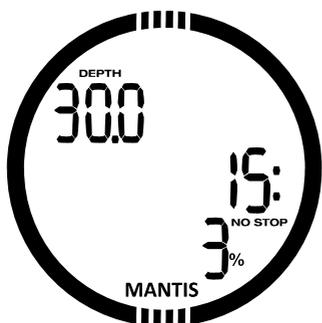
Das O<sub>2</sub>-Gasgemisch wird auf der unteren Zeile angezeigt, bis für die geplante Tiefe 1 % CNS erreicht worden ist. Nachher zeigt der Planer den CNS%-Wert auf der unteren Zeile.
