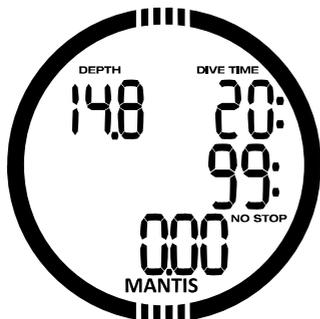
Wenn angezeigt und gestoppt, kann der Stopp-Timer durch Drücken und Halten des Knopfs -/DOWN auf Null zurückgesetzt werden.
