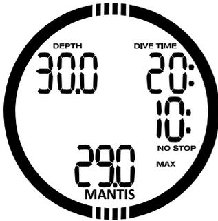
Wenn die MOD überschritten wird, blinkt in der unteren Zeile der MOD-Wert und das Symbol MAX wird angezeigt, damit Sie sehen, um wie viel Sie ihn überschritten haben. Zudem gibt der MANTIS einen konstanten Signalton aus. Solange Sie sich unterhalb der MOD befinden, blinkt der MOD-Wert und erklingt der Signalton unaufhörlich.
