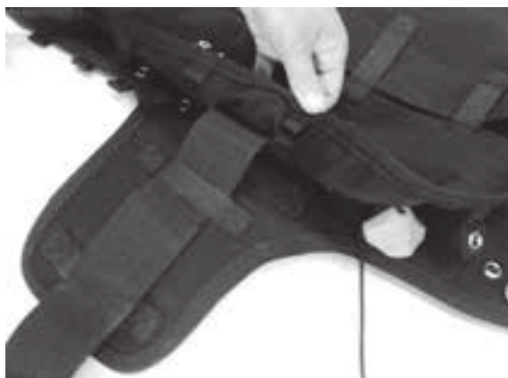
4) Trek de riem aan zodat de wing strak op het harnas vastzit
