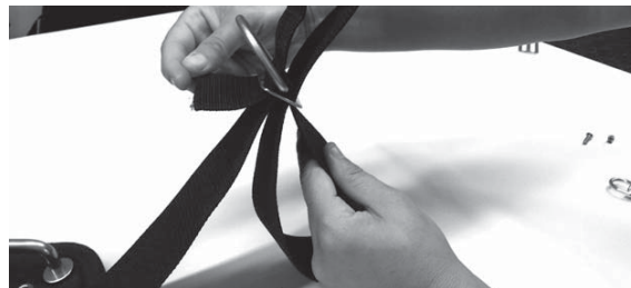
8) passare il nastro ancora una volta attraverso la prima fessura del passante ferma-nastro
