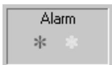
Die Alarmleiste zeigt an, welche Warnungen (roter Stern) und Vorsichtsmeldungen (gelber Stern) während des Tauchgangs ausgegeben wurden. Ausgeschaltete Vorsichtsmeldungen sind mit einem grauen Stern markiert. "OFF" bedeutet, dass der Ton komplett abgestellt war. Beachten Sie, dass die Alarmleiste bei Tauchgängen, die über DataTrak importiert wurden, nicht sichtbar ist.
